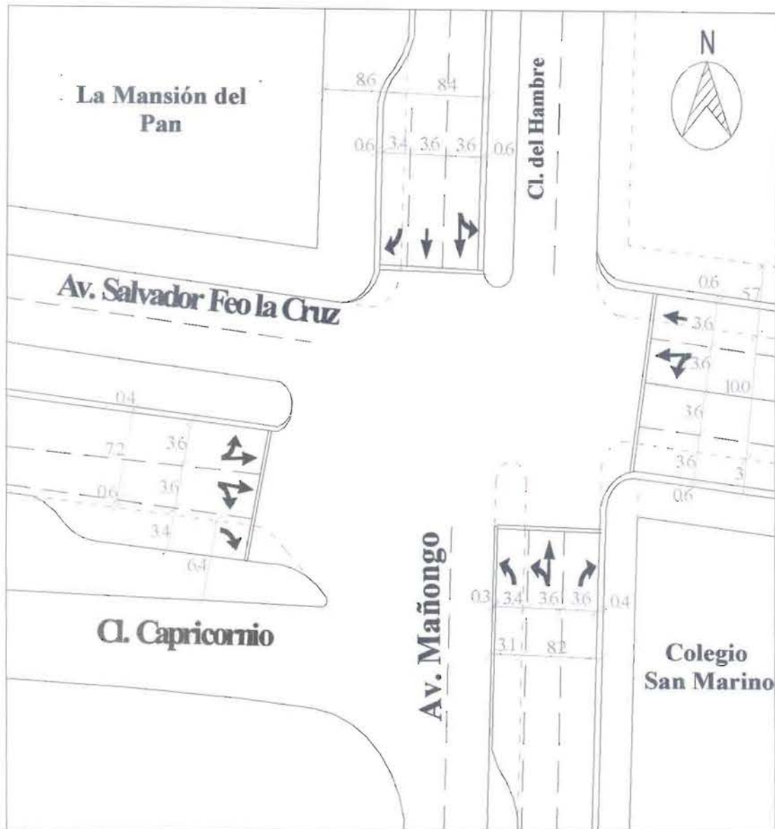
Figura 5.1 Modificaciones geométricas en Intersección 4. Fuente: Elaboración propia.
