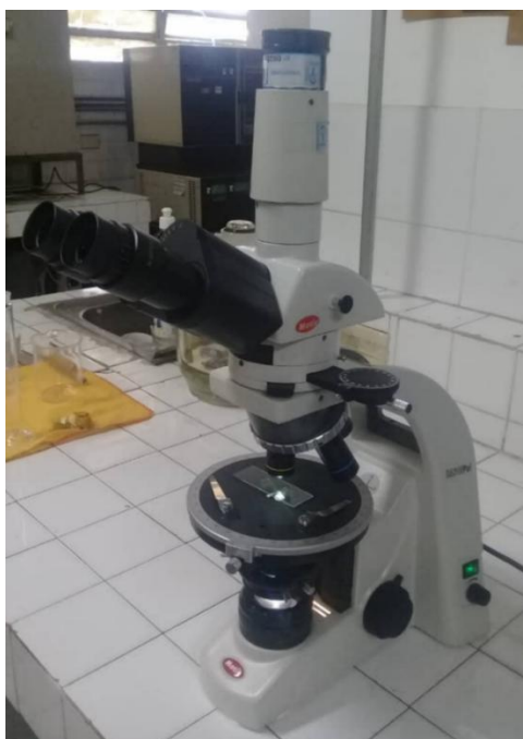
Figura 2.19. Microscopio de Polarización MOTIC BA310 POL trinocular empleado para caracterizar los sistemas SOW, ubicado en el Centro de Investigaciones Médicas y Biológicas de la Universidad de Carabobo (CIMBUC).
