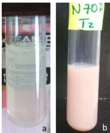
Figura 3.9. Nanoemulsiones elaboradas por el método de dilución de microemulsiones/ cristales líquidos. a) Nanoemulsión proveniente del sistema 70 (20% surf / 80% W/O) diluido con agua. b) nanoemulsión proveniente del sistema 70, diluido con agua y la adición del extracto de polifenoles.
