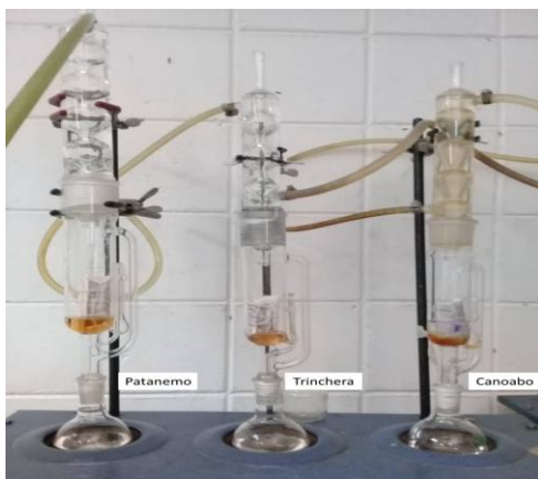
Figura 1.7. Extracción de los compuestos fenólicos con metanol de los granos fermentados y secos de cacao en equipos Soxhlet.
