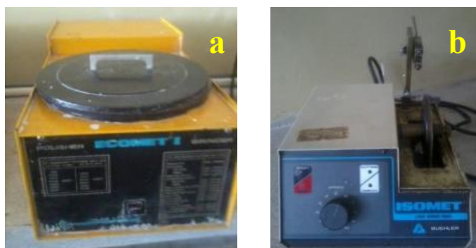
Figura 3-15: Equipos metalográficos: a) Pulidora de probetas, b) Equipo de corte fino.
