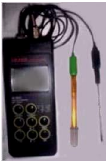
Figura 3.20: Phmetro digital HANNA instruments HI 9025 con una precisión de \pm 0,01 unidades.
