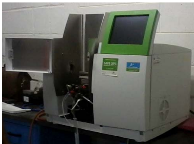
Figura 3.21: Espectrofotómetro de absorción atómica marca Perkin Elmer modelo AAnalyst 200.
