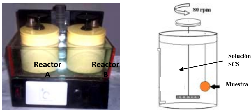
Figura 3.18: Equipo bioactivador con sus respectivos reactores A, B y esquema del reactor y muestra en la solución supersaturada (SCS).
