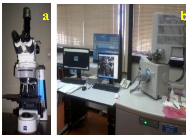
Figura 3.16: Microscopios utilizados en el análisis microestructural: a) Óptico y b) Electrónico de Barrido con EDAX acoplado.
