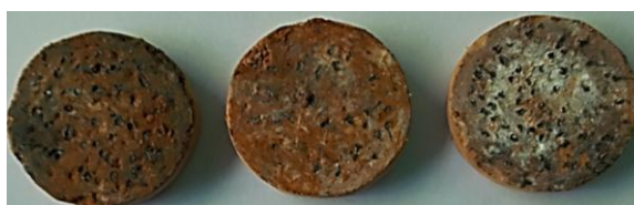
Figura 3.7: Tres de las veintisiete (27) probetas en verde cilíndricas, de izquierda a derecha: CA, CB, CC, compactadas a 600 MPa.
