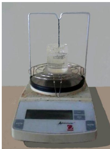
Figura 3.17: Arreglo de balanza y soporte de probeta, para el pesaje sumergido.
