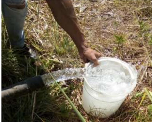
*Figura 21. Prueba del Caudal Variable. Fuente: Absalón y Bravo (2019).*
