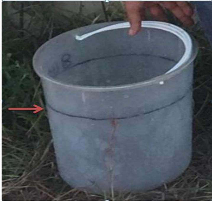
*Figura 9. Recipiente para Medir el Caudal, Capacidad 8 Litros. Fuente: Absalón y Bravo (2019).*
