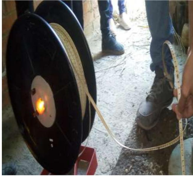
*Figura 20. Medición del Nivel Estático del Pozo Número 2. Fuente: Absalón y Bravo (2019).*
