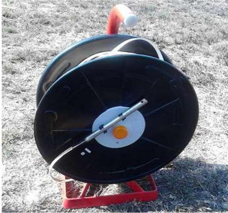
*Figura 8. Sonda para Medir Nivel, marca PLM. Fuente: Absalón y Bravo (2019).*
