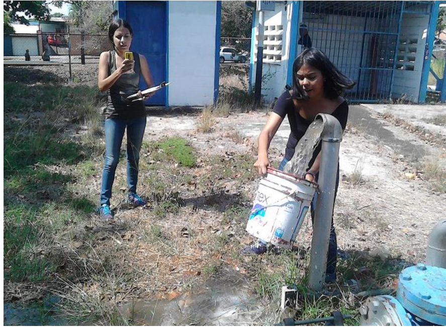
Figura 24. Medición del nivel dinámico y caudal del pozo Morro I, Coordenadas UTM 613566E; 1129798N. Elevación 462 msnm. Zona Centro, Municipio San Diego, Estado Carabobo. Fecha 05/04/2018. Fuente: Los Autores
