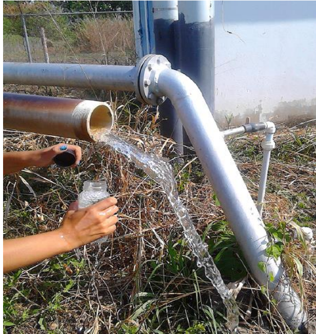
Figura 18. Toma de las muestras de agua para los estudios físico-químicos y bacteriológicos del pozo de YUMA Coordenadas UTM 614197E; 1130251N. Elevación: 463 msnm. Zona centro, Municipio San Diego, Estado Carabobo. Fecha 03/04/2018. Fuente: Los Autores
