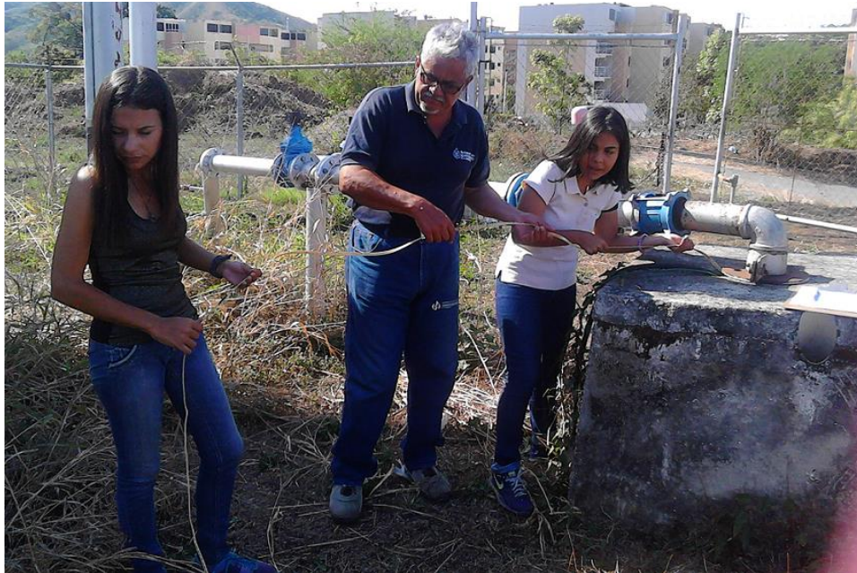
Figura 21. Medición del nivel estático del pozo YUMA en compañía del Técnico Elisaul García Coordenadas UTM 614197 E; 1130251 N. elevación 463 m.s.n.m Zona Centro, Municipio San Diego, Estado Carabobo. Fecha 22/03/2018. Fuente: Los Autores
