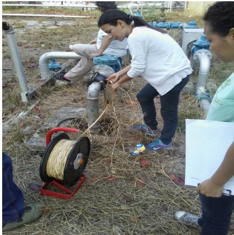
Figura 15. Medición del nivel estático del pozo Morro I, en compañía del técnico Elisaul García Coordenadas UTM 613566E; 1129798N. Elevación 462 msnm. Zona Centro, Municipio San Diego, Estado Carabobo. Fecha 08/03/2018. Fuente: Los Autores
