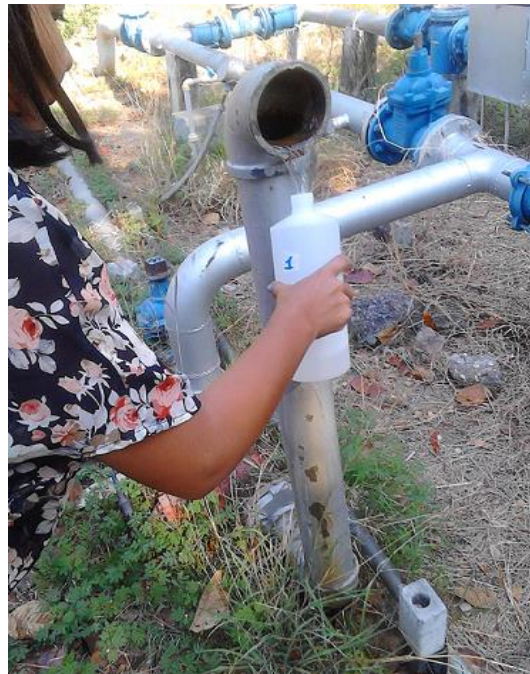
Figura 17. Toma de las muestras de agua para los estudios físico-químicos y bacteriológicos del pozo del Morro I Coordenadas UTM 613566E; 1129798 N. Elevación: 462 msnm. Zona centro, Municipio San Diego, Estado Carabobo. Fecha 03/04/2018. Fuente: Los Autores
