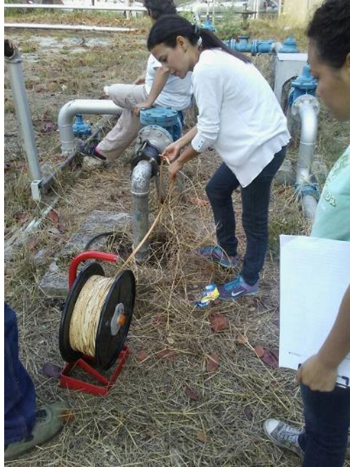
Figura 50. Medición del nivel estático del pozo Morro I, en compañía del técnico Elisaul García Coordenadas UTM 613566E; 1129798N. Elevación 462 msnm. Zona Centro, Municipio San Diego, Estado Carabobo. Fecha 08/03/2018. Fuente: Los Autores
