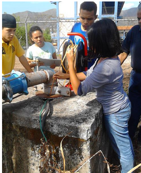
Figura 52. Medición del nivel estatico del pozo YUMA en compañía del Técnico Elisaul García. Coordenadas UTM 614197 E; 1130251 N. Elevacion 463 m.s.n.m. Zona Centro, Municipio San Diego, Estado Carabobo. Fecha 08/03/2018. Fuente: Los Autores
