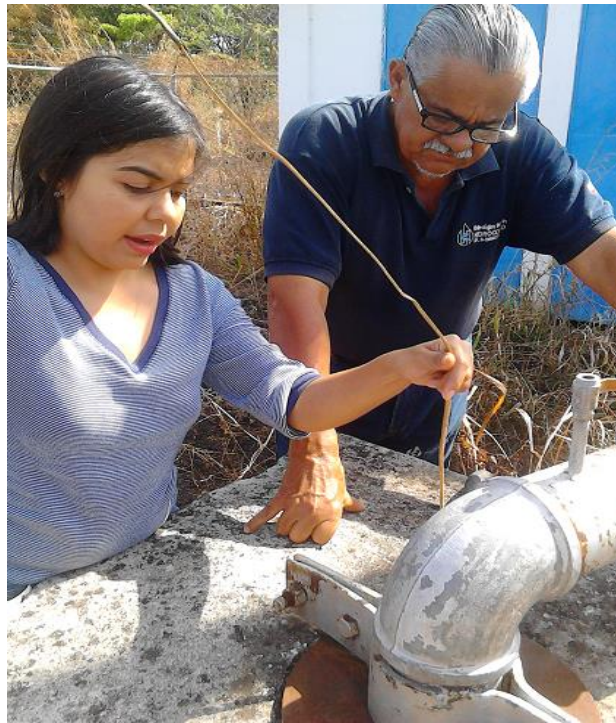
Figura 19. Medicion del nivel estatico del pozo YUMA en compañía del Tecnico Elisaul Garcia. Coordenadas UTM 614197 E; 1130251 N. Elevacion 463 m.s.n.m. Zona Centro, Municipio San Diego, Estado Carabobo. Fecha 08/03/2018. Fuente: Los Autores
