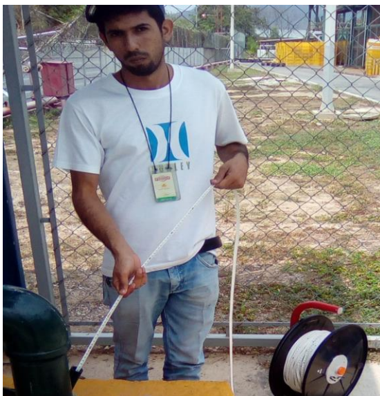
FIGURA 23. Medición de Niveles en el pozo N°13 de Proagro. Coordenadas UTM Protinal Proagro Planta Embutidos UTM (614668 E; 1126507N). Elevación: 444 msnm. Zona Industrial, Municipio San Diego, Estado Carabobo Fecha: 31/03/2017
