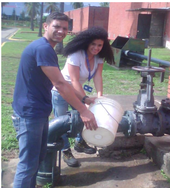
FIGURA 25. Prueba de Caudal Variable en el pozo de Bigott. Coordenadas UTM 613950E; 1127884N. Elevación: 434 msnm. Zona Industrial Castellito, Municipio San Diego, Estado Carabobo. Fecha: 10/04/17
