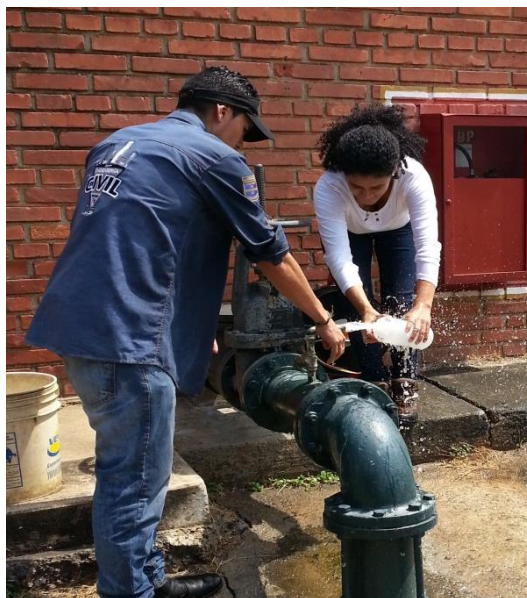
FIGURA 18. Toma de las muestras para el análisis físico-químico y bacteriológico del agua del pozo Bigott UTM 613950 E, 1127884 N. Elevación: 434 msnm. Zona Industrial, Municipio San Diego, Estado Carabobo. Fecha: 24/01/2017
