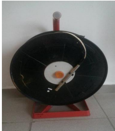
FIGURA 8. Sonda para medir nivel marca PLM Fuente: Elaboración propia
