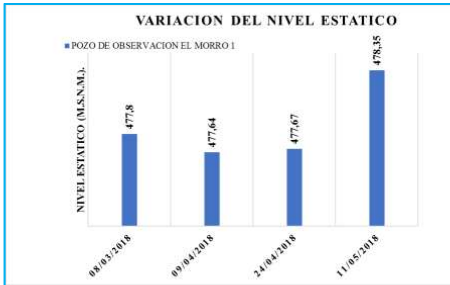
Figura 4.13 Variación del Nivel Estático durante el periodo de mediciones del pozo de la Urb. El Morro I, zona Centro A, municipio San Diego, estado Carabobo.
