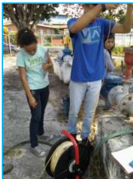
Figura 3.8 Medición del nivel freático (estático) pozo El Morro I, zona Centro A, municipio San Diego, estado Carabobo.
