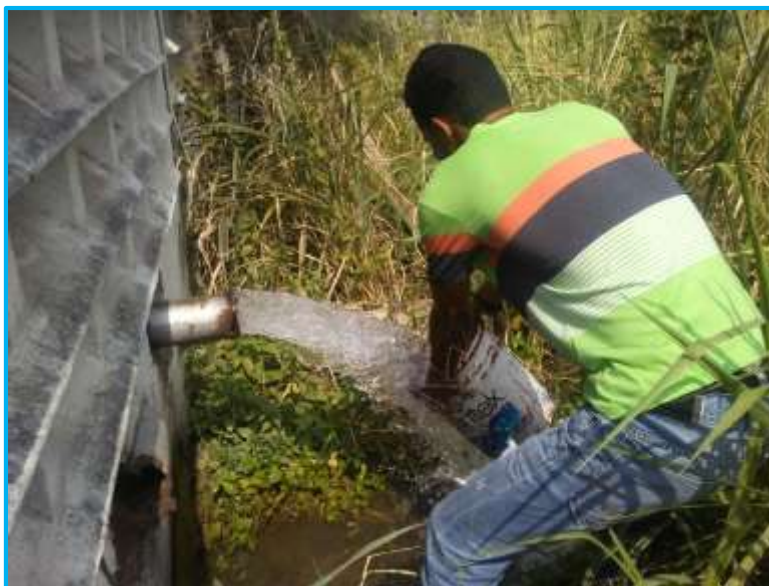
Figura 3.7 Medición de caudal del pozo La Esmeralda, zona Centro A, municipio San Diego, estado Carabobo.
