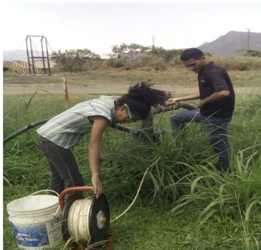
**Figura 19. Medición del nivel freático del pozo Iamdesandi (estático).**
