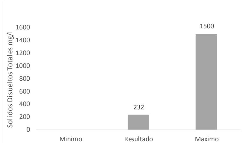
**Figura 29. Comparación de los resultados de los Sólidos Disueltos Totales realizados el 07/02/2017 respecto a las normas sanitarias de calidad de agua potable, gaceta n 36.395, pozo Iamdesandi de Coordenadas UTM 613796E; 1130970N. Elevación: 459 msnm. Zona centro, Municipio San Diego, Edo. Carabobo**
