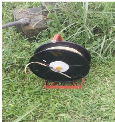
**Figura 7. Sonda marca PLM utilizada para medir nivel.**
