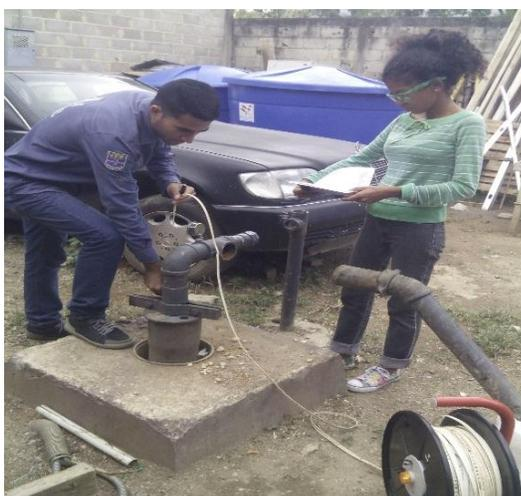
**Figura 23. Medición de nivel estático del pozo de observación Coordenadas UTM 613503E; 1134139N. Elevación: 469 msnm. Zona norte, Municipio San Diego, Edo. Carabobo. Fecha: 03/04/2017.**
