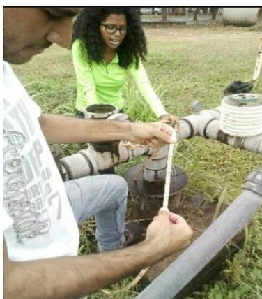
**Figura 47. Medicion de nivel del pozo Iamdesandi de coordenadas UTM 613796E; 1130970N; elevación 459 m.s.n.m. Municipio San Diego, Estado Carabobo. Fecha: 23/03/2017.**
