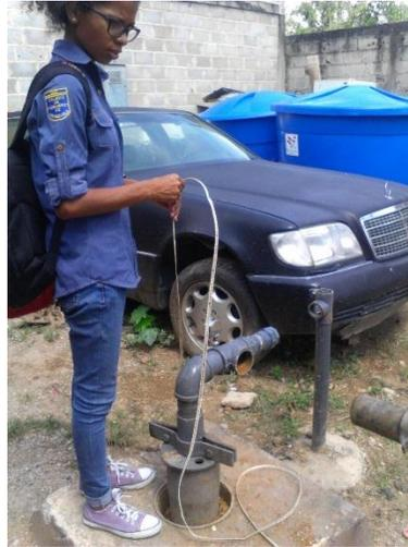
**Figura 50. Medición de nivel estático del pozo de observación Coordenadas UTM 613503E; 1134139N. Elevación: 469 msnm. Zona norte, Municipio San Diego, Edo. Carabobo. Fecha: 03/04/2017**
