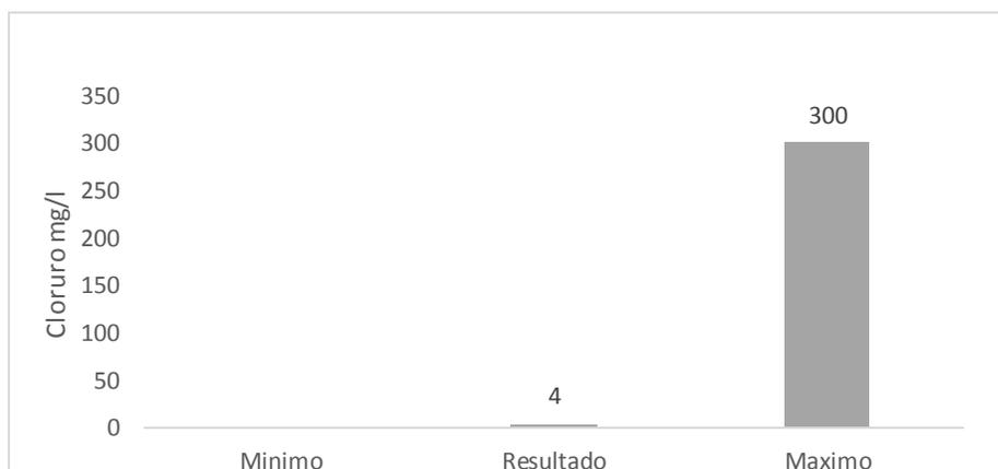
**Figura 32. Comparación de los resultados del Cloruro realizados el 07/02/2017 respecto a las normas sanitarias de calidad de agua potable, gaceta n 36.395, pozo Iamdesandi de Coordenadas UTM 613796E; 1130970N. Elevación: 459 msnm. Zona centro, Municipio San Diego, Edo. Carabobo**
