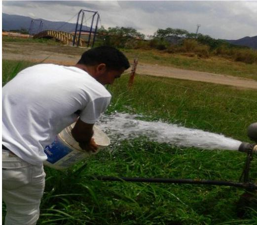
**Figura 20. Medición del caudal del pozo Iamdesandi. Coordenadas UTM 613796E; 1130970N. Elevación: 459 msnm. Zona centro, Municipio San Diego, Edo. Carabobo. Fecha: 31/03/17.**
