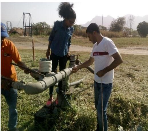
**Figura 24. Medición de nivel estático del pozo IAMDESANDI en compañía de José Verdespina Coordenadas UTM 613796E; 1130970N. Elevación: 459 msnm. Zona centro, Municipio San Diego, Edo. Carabobo. Fecha: 05/04/2017.**
