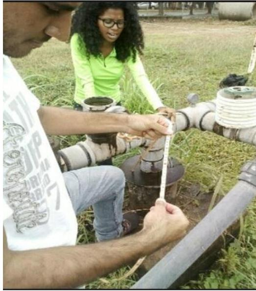
**Figura 18. Lectura del nivel freático del pozo Iamdesandi (estático).**
