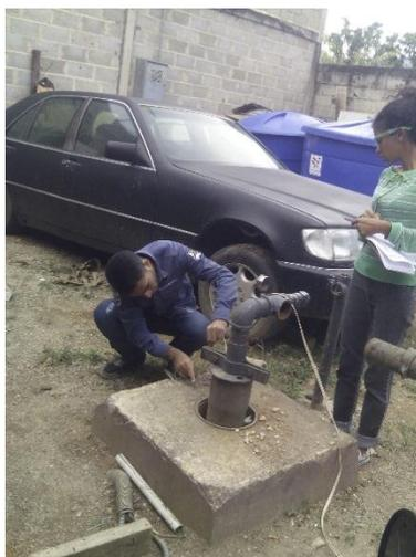
**Figura 49. Medición de nivel estático del pozo de observación Coordenadas UTM 613503E; 1134139N. Elevación: 469 msnm. Zona norte, Municipio San Diego, Edo. Carabobo. Fecha: 03/04/2017**
