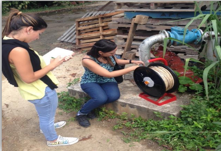
Figura3. Proceso de recolección de datos y medición de nivel en el Pozo en el Remanso, Aves del Paraíso. Coordenadas 614992E; 1133241N. Municipio San Diego, Estado Carabobo. Fecha: 20/10/2015.
