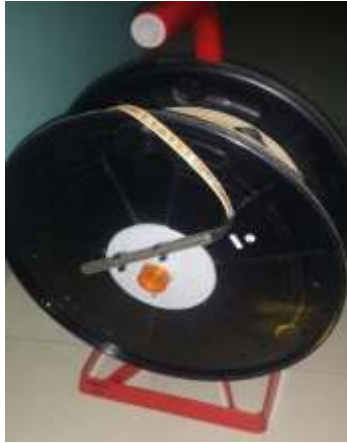
Figura 3 Sonda marca PLM equipamiento usada para medir nivel. Fuente: Los Autores
