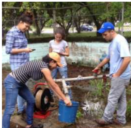
Figura 15 Medición de nivel en el Pozo # 6 de A.C conjunto residencial El Tulipán. Coordenadas 613.536,88E; 1.134.540,80 N, elevación 480 m.s.n.m,
