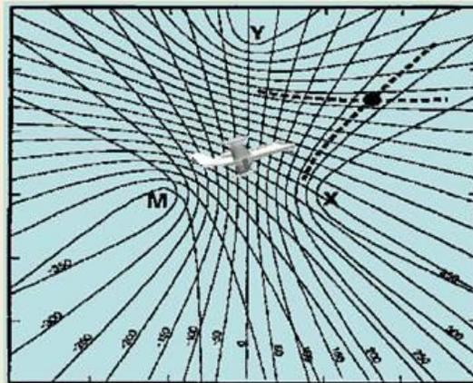
Los sistemas de navegación por satélite determinan la posición de cualquier aeronave según las tres coordenadas de posición, espacio y tiempo. Uno de estos sistemas es el LORAN: es un sistema de navegación hiperbólica radioeléctrico e largo alcance, que opera en baja y media frecuencia.
