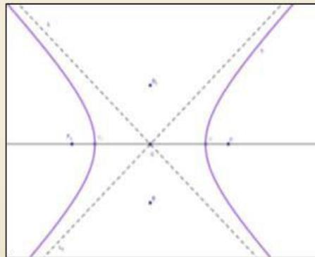
Los elementos de una hipérbola se muestran en la figura las cuales son: el centro  $C$ , los vértices reales  $V$  y  $V1$ , los vértices conjugados  $B$  y  $B1$ , los focos  $F$  y  $F1$ , las asíntotas que son las dos rectas que limitan la abertura de cada rama de la curva, mientras que la línea recta que contiene el eje focal se le denomina eje de la hipérbola.
