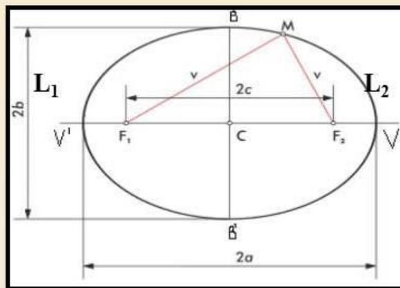
Los elementos que se observan son los indispensables para encontrar dicho lugar geométrico: C es el centro de la elipse, el segmento  $\overline{V'V}$  es el eje mayor y está incluido en la recta que constituye el eje de la elipse, el segmento  $\overline{B'B}$  corresponde al eje menor, el eje focal está constituido por  $\overline{F'F}$  y las rectas L1 y L2 denominadas directrices, las cuales van a formar parte de la curva construida.
