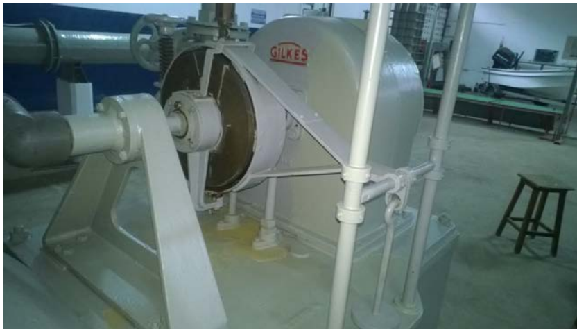
Figura 2.5 Freno Prony Acoplado a la Turbina Pelton del banco de ensayos del Laboratorio de hidráulica UC.
