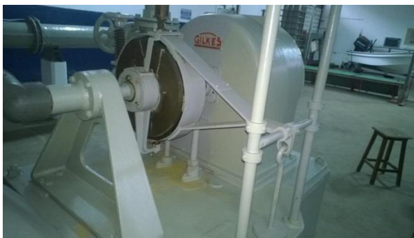
Figura B.8 Freno Prony de la turbina Pelton del laboratorio de Hidráulica “Elías Sánchez Díaz” –UC. 1) Válvula de entrada a la turbina Pelton, 2) válvula de recorrido del punzón, 3) punzón y tobera de entrada y 4) Cucharas.
