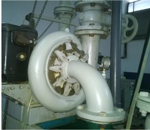
Figura B.2 Turbina Francis del laboratorio de Hidráulica “Elías Sánchez Díaz” de la Universidad de Carabobo.
