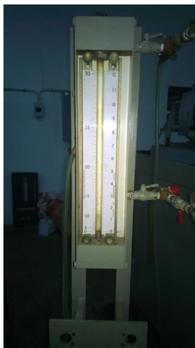
Figura B.9 Piezómetro para medición d caudal del laboratorio de Hidráulica “Elías Sánchez Díaz” de la Universidad de Carabobo.
