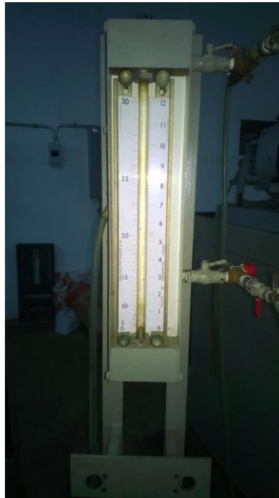
Figura B.5 Piezómetro para medición d caudal del laboratorio de Hidráulica “Elías Sánchez Díaz” de la Universidad de Carabobo.
