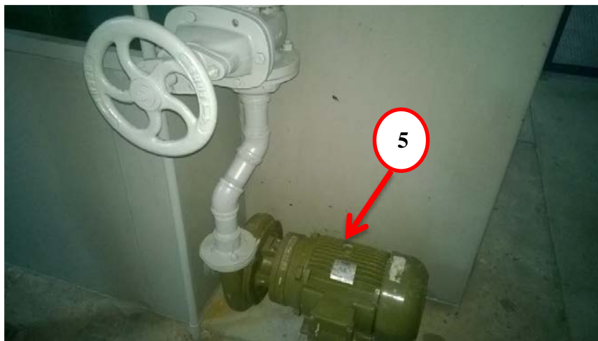
Figura 2.7. Banco de ensayos de los Sistemas de Turbina Francis y Turbina Pelton del Laboratorio de Hidráulica. 5 bomba auxiliar del Banco de ensayos.
