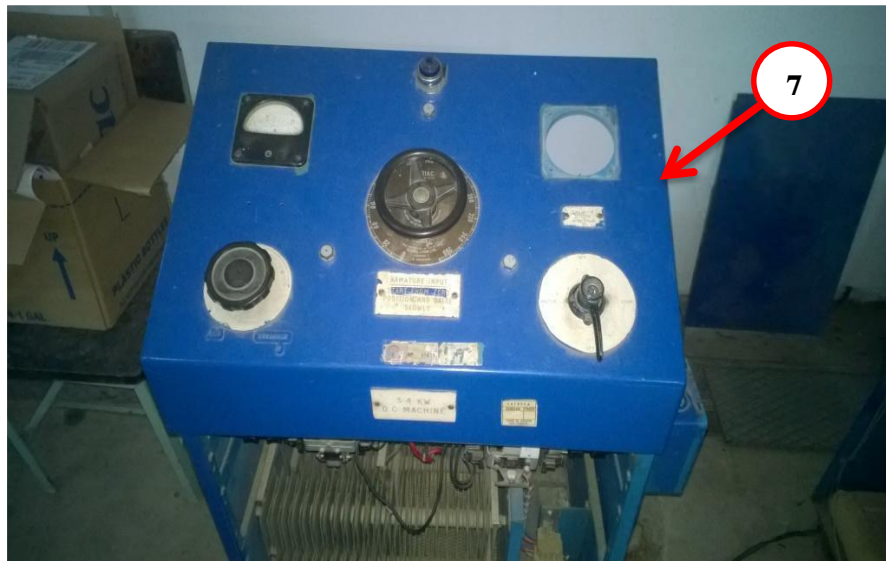
Figura 2.9. Banco de ensayos de los Sistemas de Turbina Francis y Turbina Pelton del Laboratorio de Hidráulica. 7 Panel eléctrico para control de la Bomba Auxiliar y el Generador Eléctrico de la Turbina Francis.
