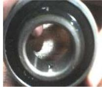
*Figura 3.1:* Cojinete con falla en pista interna
