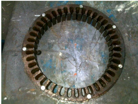
(a): Estator una vez retirado el devanado anterior.
