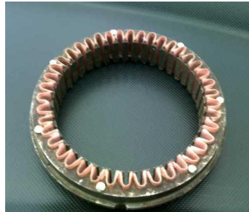
(b): Acondicionamiento del estator para colocar el nuevo devanado
