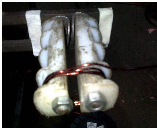
(c): Construcción de las bobinas
