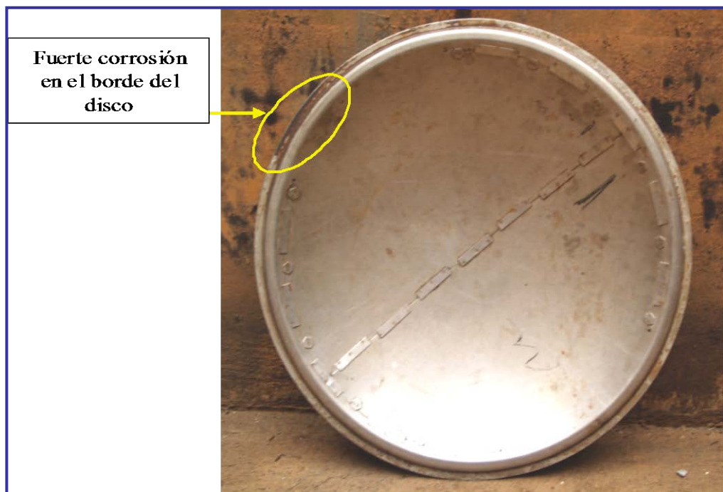
Figura IV.18: Evidencia de corrosión en borde del disco de ruptura. Fuente PDVSA
