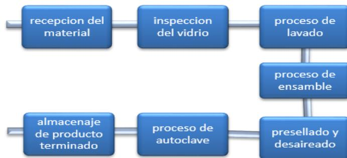
**Figura 6.** Diagrama de bloques del proceso.
