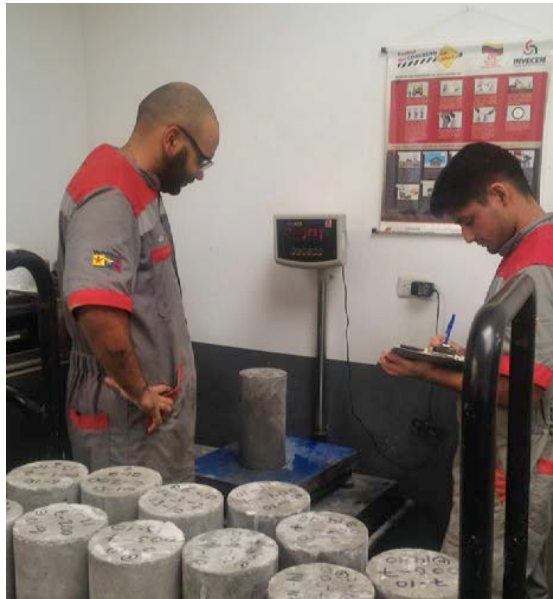
Figura 29. Foto del proceso de pesado de vigas cilíndricas.
