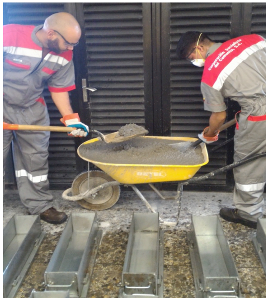
Figura 30. Foto del proceso de llenado de probeta en forma de paralelepípedo.
