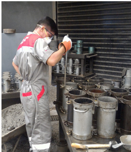
Figura 27. Foto de probeta cilíndrica siendo compactada
