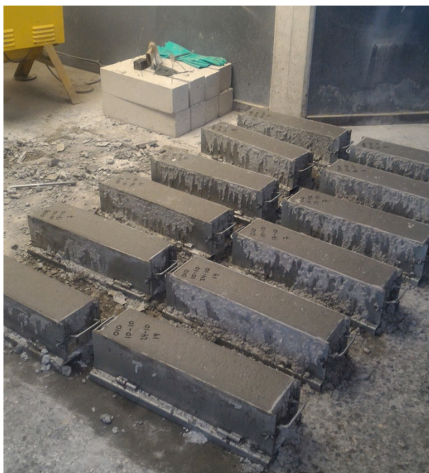
Figura 25. Foto de vigas de pavimento en forma de paralelepípedo recién tomadas.
