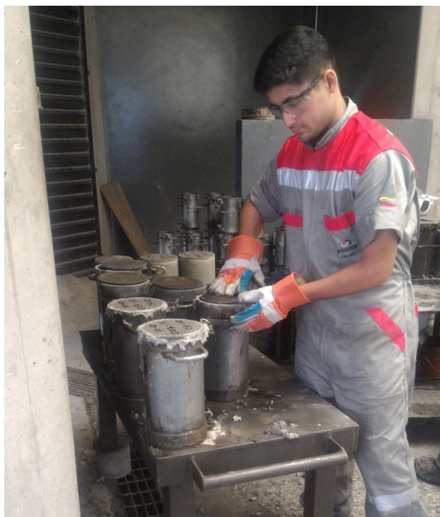
Figura 28. Foto de probeta cilíndrica siendo desencofrada.
