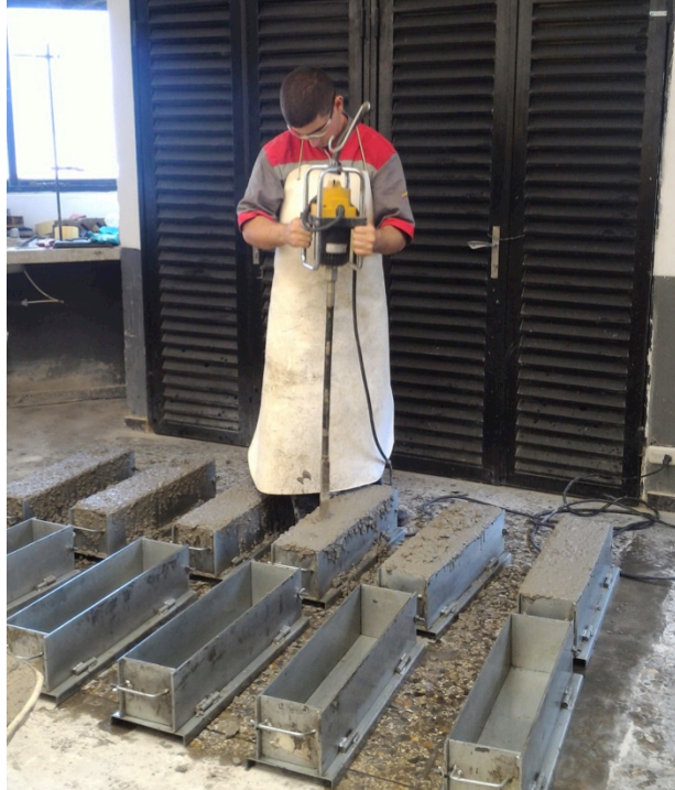
Figura 26. Foto de vigas de pavimento en forma de paralelepípedo siendo compactadas.
