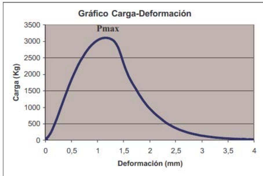
Figura 2. Curva carga-deformación resultante del ensayo de tracción indirecta
