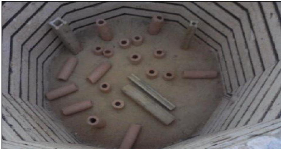
Figura 16. Catalizadores de Pentóxido de vanadio luego de la cocción.
