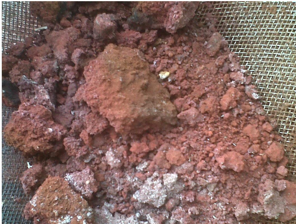
Figura 15. Oxido ferroso después del tratamiento térmico.
