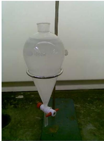
Figura 18. Extracción líquido-líquido de la muestra
