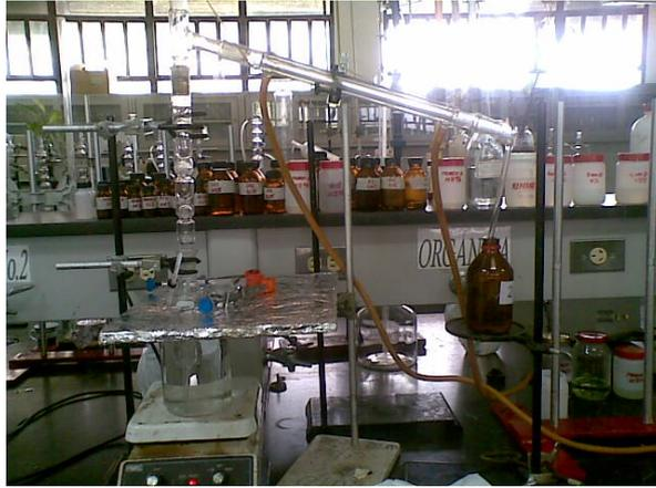
Figura 20. Montaje de concentración empleando la Kuderna-Danish
