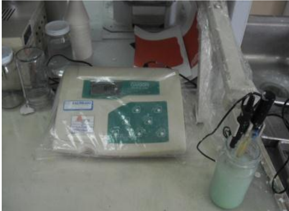
Anexo 1.2: pHmetro empleado para la determinación de pH del agua de proceso, agua tratada y pilotos de pintura emulsionada económica.
