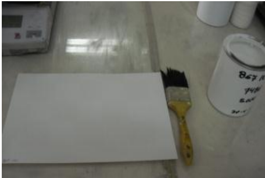
Figura A.1 Prueba de brochabilidad aplicada a la pintura emulsionada
