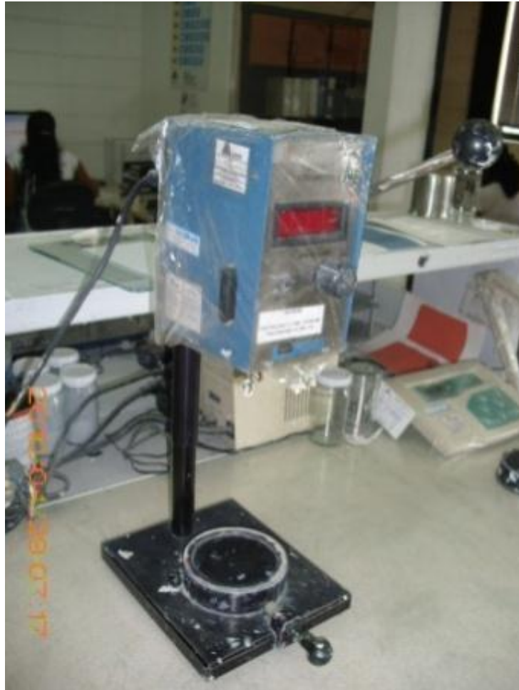
Anexo 1.5: Viscosímetro Stormer utilizado para la determinación de la viscosidad de los pilotos de pintura emulsionada económica.
