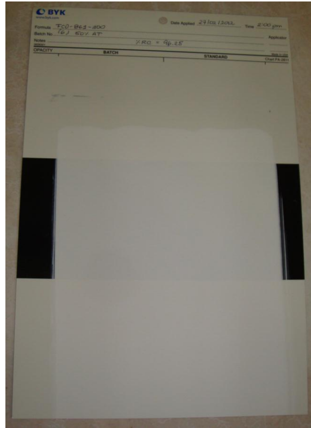
Figura A.2 Aplicación de la pintura emulsionada sobre la cartulina cromokote para la evaluación de la relación de contraste
