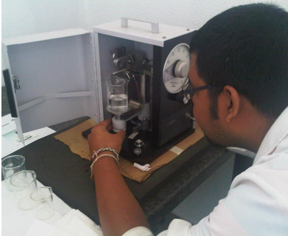
Anexo 1.3: Tensiómetro de anillo utilizado para la medición de tensión superficial del agua tratada y agua de proceso. (Cole Parmer, Surface Tensiomat 21 ®)
