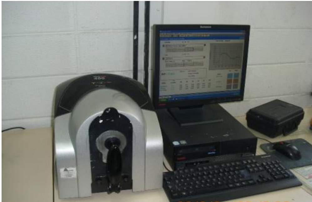
Anexo 1.4: Espectrofotómetro empleado para determinar la relación de contraste y color de las aplicaciones de pintura.
