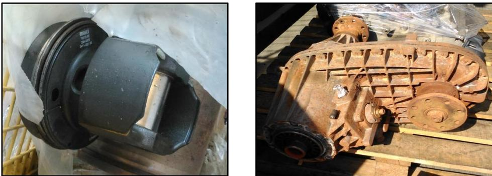
**Figura 2.** Componentes y repuestos críticos sin protección.
