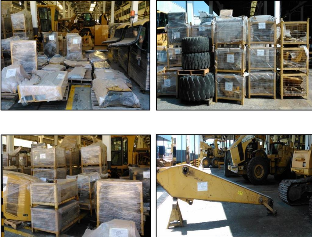
**Figura 3.** Almacenamiento indebido de componentes en áreas de trabajo.
