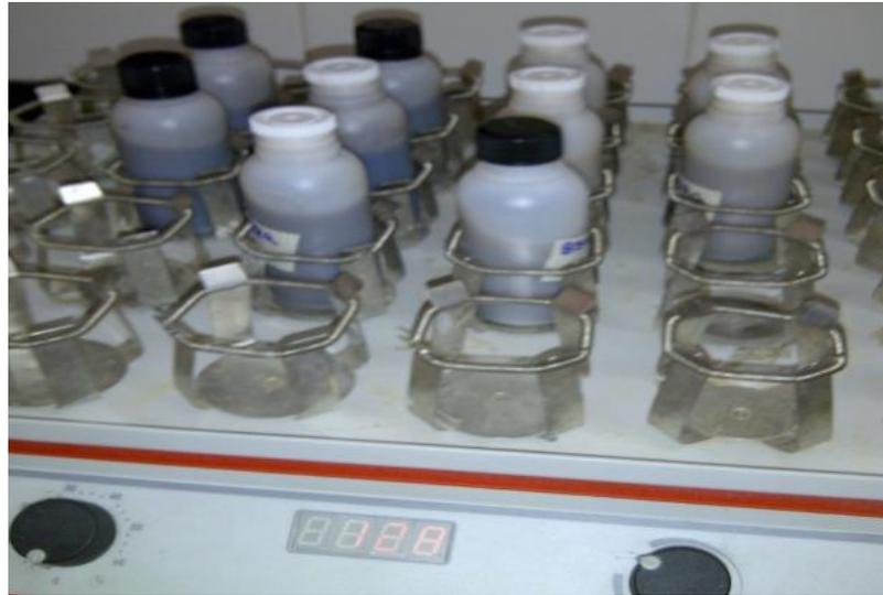
**Figura 6. Muestras de suelo en agitación con de NaOH/Na<sub>4</sub>P<sub>2</sub>O<sub>7</sub> 0,1 M.**
