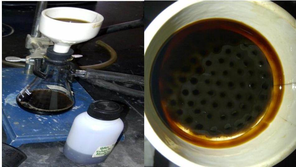
**Figura 8. Filtración al vacío para separar las huminas del extracto alcalino por medio de filtros de membrana de 0,2  $\mu\text{m}$ .**
