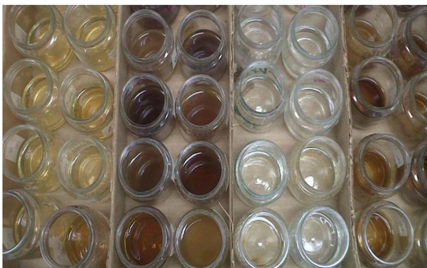
Figura 12. Alícuotas de cada una de las fracciones CE, AH, AF, SNH antes de evaporar
