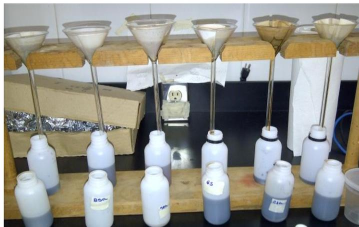
**Figura 7. Filtración por gravedad de las muestras de suelos tratadas con NaOH/Na<sub>4</sub>P<sub>2</sub>O<sub>7</sub> 0,1 M.**
