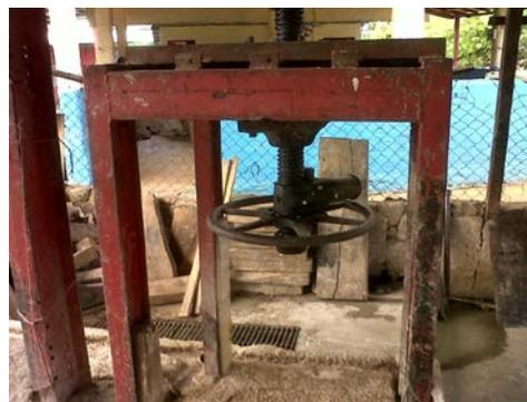
**Figura 3.6. Prensa artesanal utilizada en el proceso de elaboración del casabe.**
