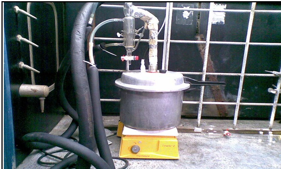
Figura 2.3. Equipo de destilación por arrastre con vapor
