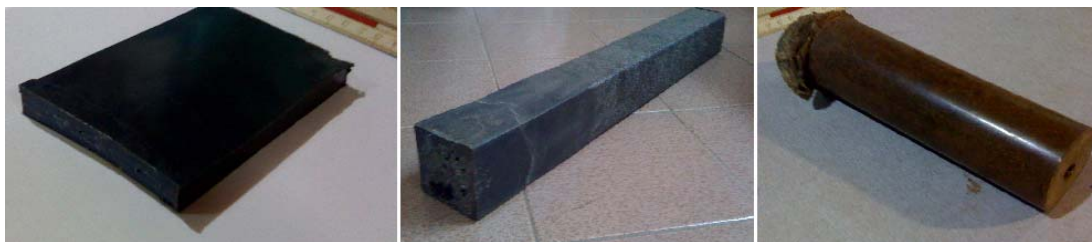
Figura 4.6 – Prototipos de madera plástica: perfil rectangular (tabla), perfil cuadrado (listón) y perfil circular (barra).
