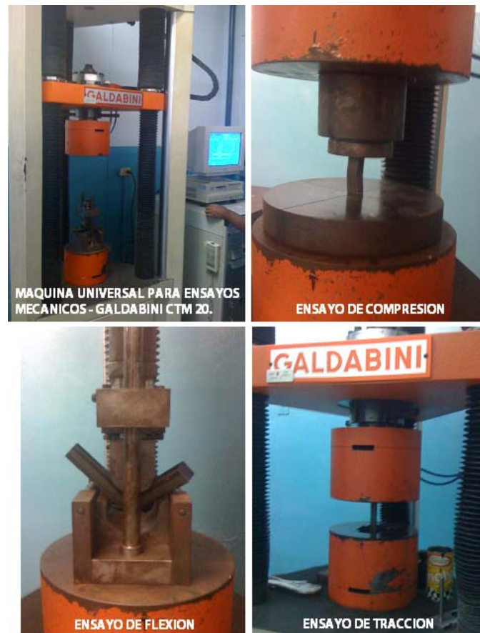
Figura 4.8 – Máquina Galdabini para ensayos mecánicos, Universidad de Carabobo.
