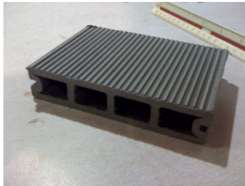
Figura 4.7 – Perfil de madera plástica de Maderplast, Colombia.
