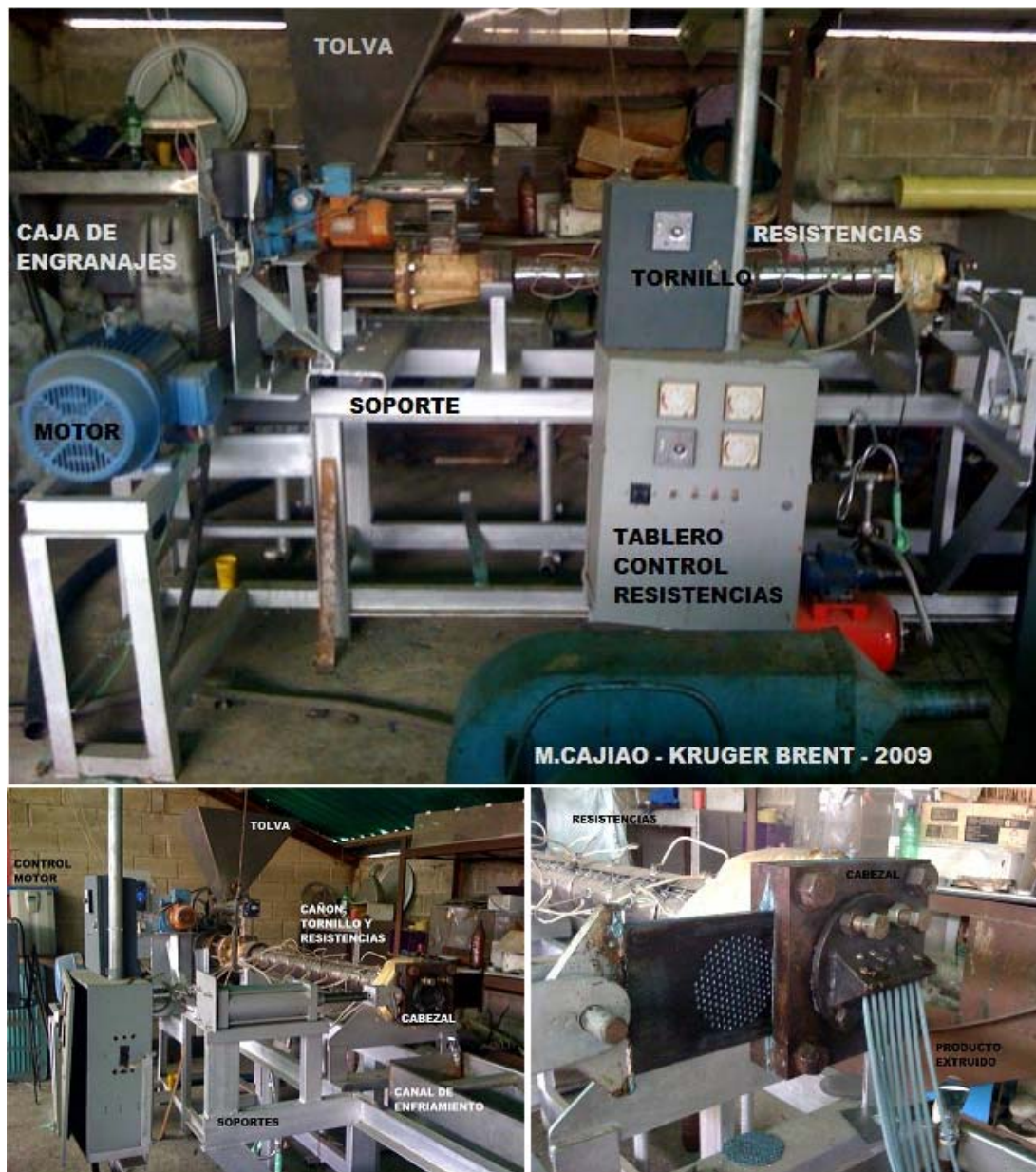
Figura 4.3 – Extrusora mono-husillo fabricada en Kruger - Brent en Valencia, Venezuela.
