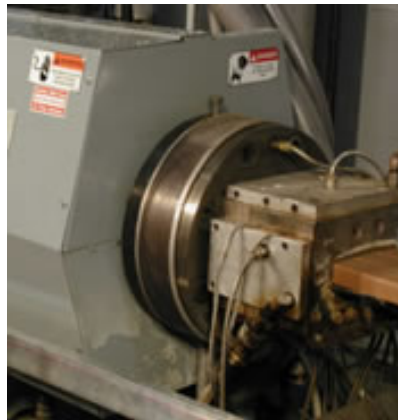
Figura 2.5 – Dado o cabezal de una extrusora produciendo un perfil de compuesto de madera plástica.
