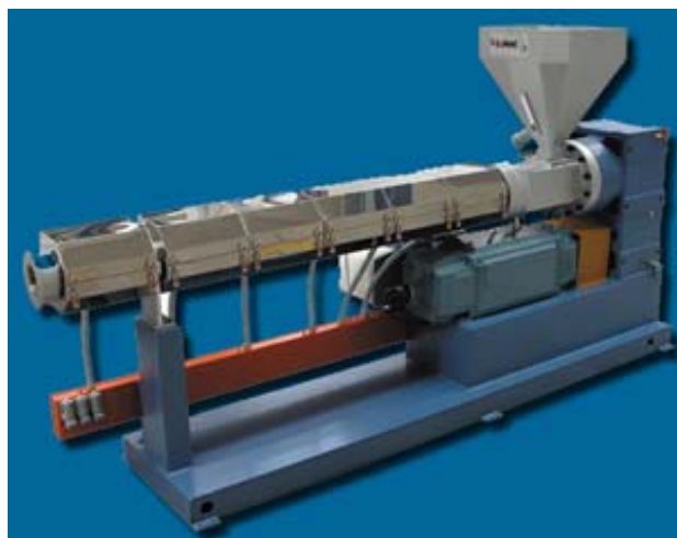
Figura 2.4 – Extrusora mono-husillo para perfiles de compuestos de madera plástica. Fuente: Bg Plast, 2006
