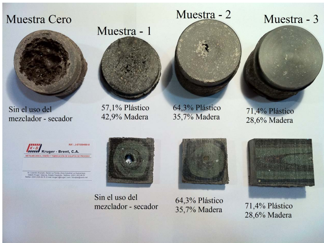
Figura 4.5 – Muestras de madera plástica elaboradas con diferentes formulaciones.
