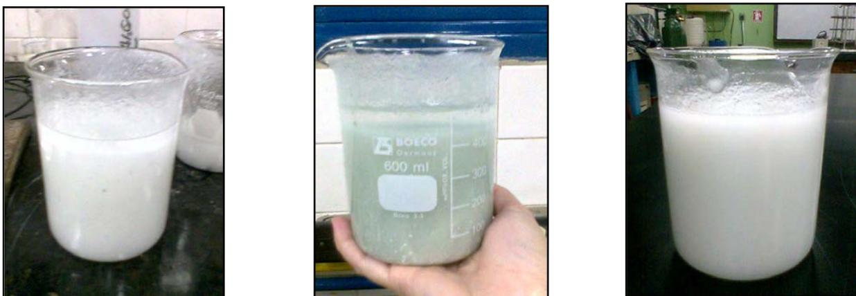
Figura 2. Lodo formado luego del tratamiento de las muestras de agua residual 4-A (izquierda), 7-O (medio) y mezcla (derecha).
