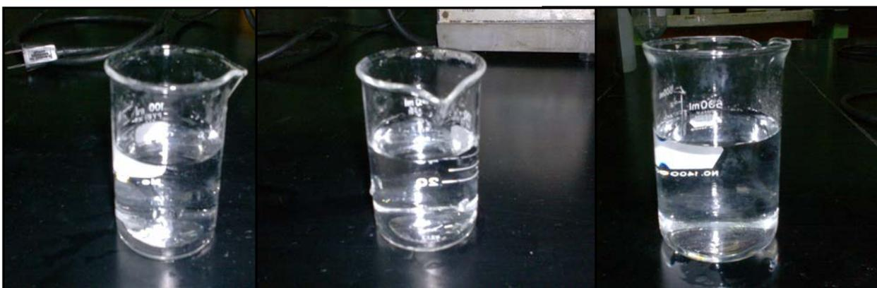
Figura 3. Muestras 4-A (izquierda), 7-O (medio) y mezcla (derecha) tratadas mediante coagulación-floculación.
