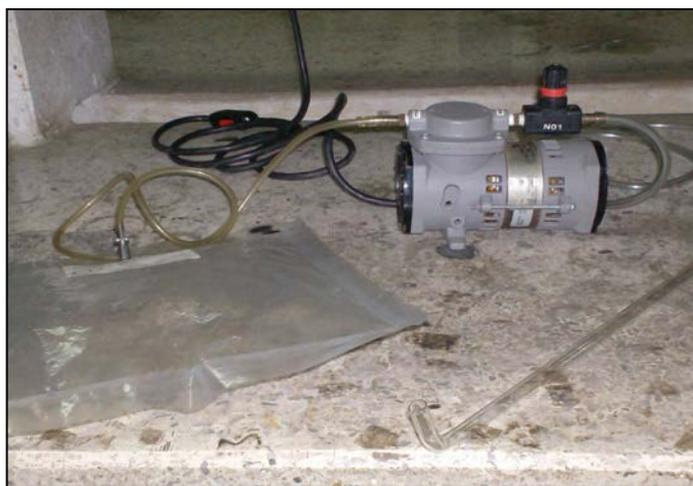
**Figura 3.4. Equipo utilizado para captar las muestras gaseosas**
