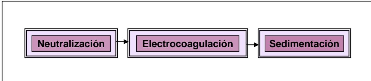
**Figura 4.22. Diagrama de bloque de la alternativa 2**
