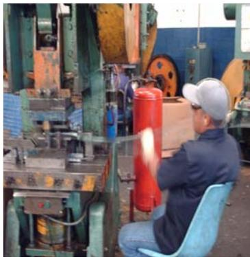
Figura 1.1 Operador alimentando la prensa halando el material directamente del porta-jumbo.
