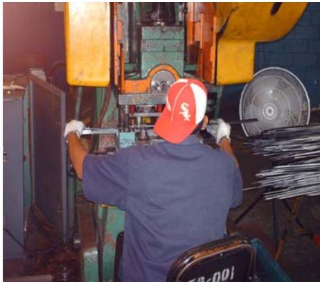
Figura 1.3 Operador alimentando la prensa utilizando tiras metálicas previamente cortada.
