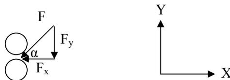
Figura 4.16. Reacción de los rodillos por acción de la fuerza  $F_1$ .
