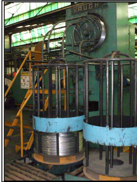
FIGURA N°2.4: Momento en el que la máquina de trefilado llena una cesta de alimentación con alambre. (Fuente: L. Alvarez, 2007)
