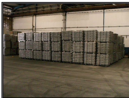
FIGURA N°2.1: Lingotes de aluminio dispuestos para ser fundidos en los hornos (Fuente: L. Alvarez, 2007)
