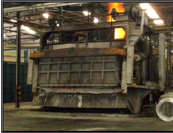
FIGURA N°2.2: Horno de fundición de 32TM de la línea FENN. (Fuente: L. Alvarez, 2007)
