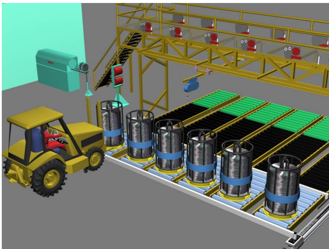
FIGURA N°4.7: Ubicación de la última cesta de alimentación llena en la zona de carga mediante el montacargas. ( Fuente: L. Alvarez, 2007)
