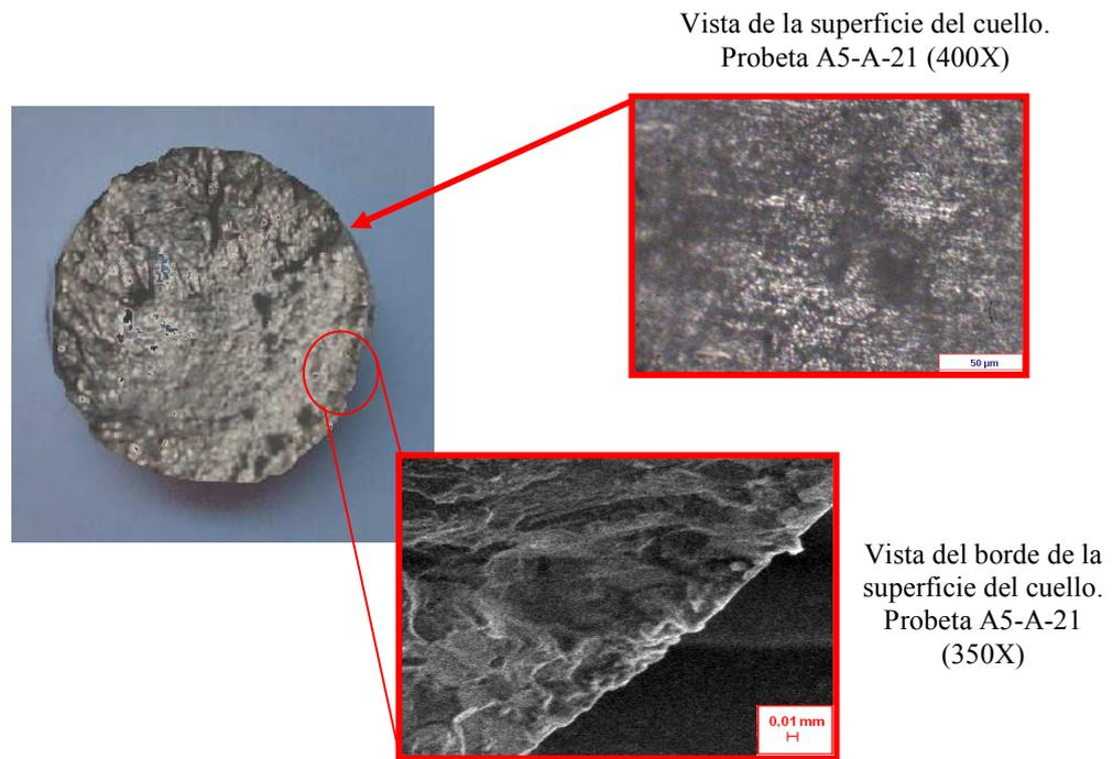
**Figura 4.23.** Proporciones relativas de la zona de rotura en presencia de ácido sulfúrico al 5%.
