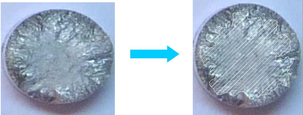
**Figura 4.14.** Foto de la superficie de fractura en la probeta CO-A-6
