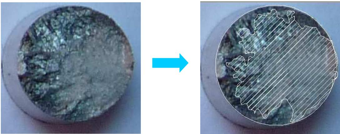
**Figura 4.16.** Foto de la superficie de fractura en la probeta A5-A-4
