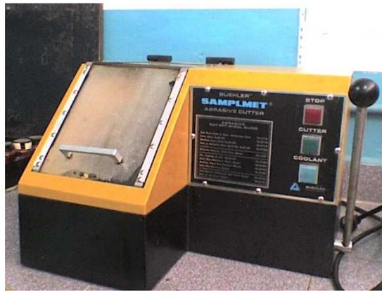
**Figura 3.3** Cortadora Metalográfica.
