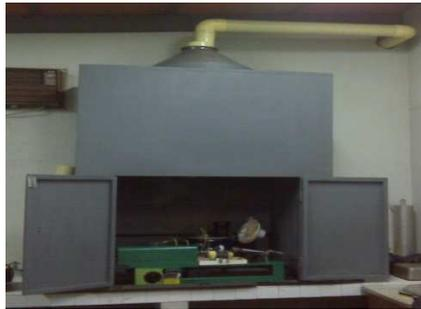
Figura 3.10. Campana para extracción de vapores perjudiciales.
