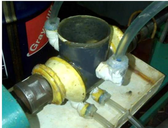
Figura 3.11. Dispositivo contenedor del ácido.
