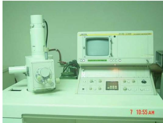
Figura 3.8 Microscopio Electrónico de Barrido.
