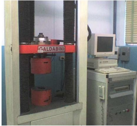
Figura 3.4 Máquina de Ensayo universal.
