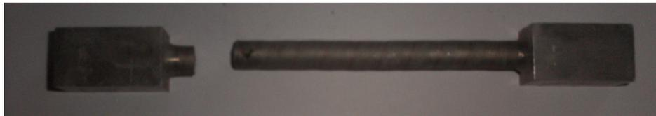
**Figura 4.16** Condición de la probeta N° 1 una vez finalizado el ensayo.
