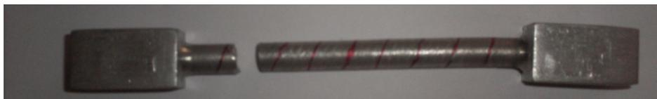
**Figura 4.10** Condición de la probeta N° 1 una vez finalizado el ensayo.
