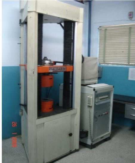
**Figura 3.16** Máquina universal para ensayos de tracción.
