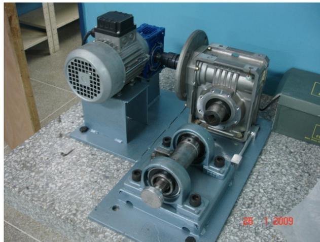
**Figura 3.15** Máquina para ensayo de torsión.
