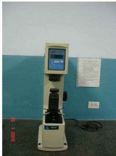
**Figura 3.17** Durómetro Digital Rockwell.
