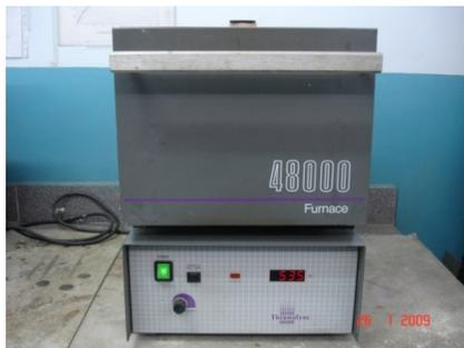
**Figura 3.14** Horno para tratamientos térmico.
