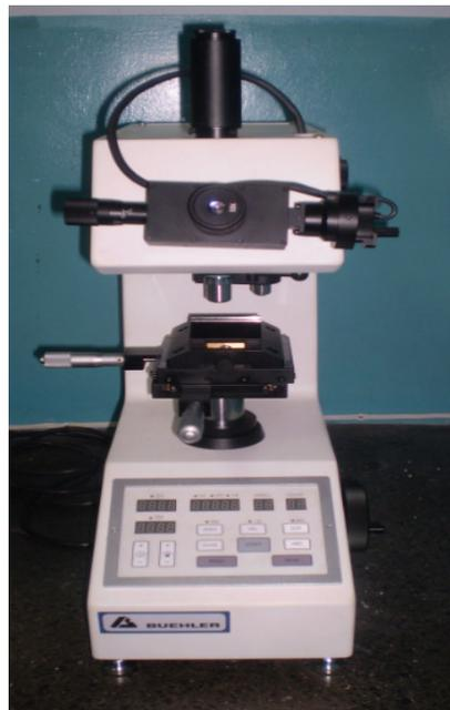
**Figura 3.19** Microdurómetro Vickers.
