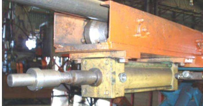
**Figura 4.42.** Cilindro oleohidráulico empleado actualmente para acoplar la barra a la mordaza del torno
