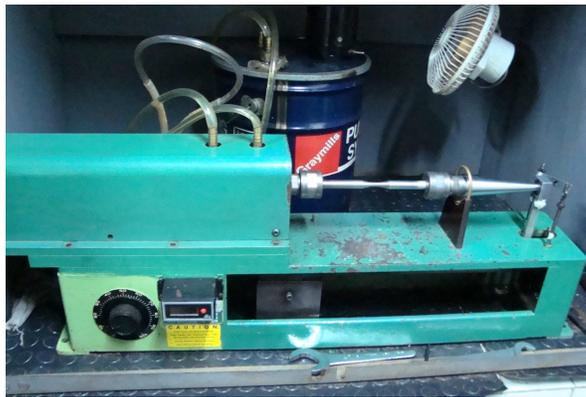
**Figura 3.7** Máquina de ensayo de fatiga
