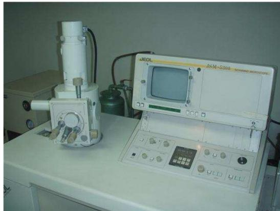
**Figura 3.8** Microscopio electrónico de barrido
