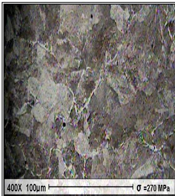
**Figura 4.18** Microestructura del Acero AISI 1045, Condición Temple 400X (N = 28.700)
