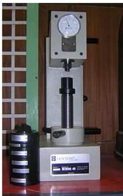
**Figura 2.2** Durómetro (Enciclopedia de Ciencia y Técnica)
