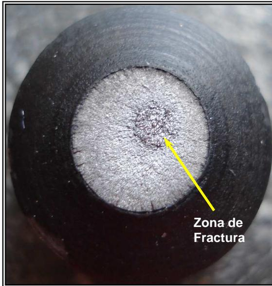
**Figura 4.32** Macrofotografía del Acero AISI 1045, Condición Temple ( $\sigma = 270$  Mpa,  $N = 28.700$ )
