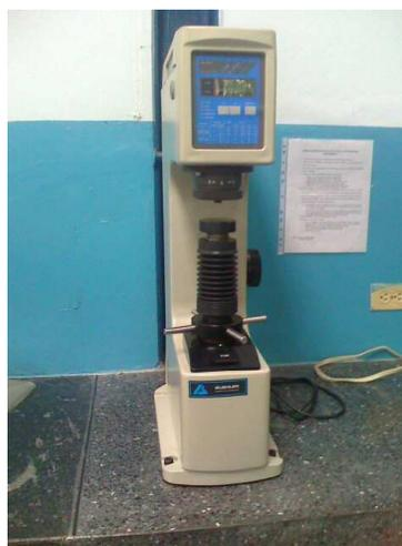
**Figura 3.6** Máquina de ensayo de dureza
