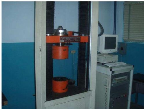
**Figura 3.5** Máquina de ensayo a tracción
