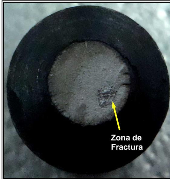
**Figura 4.35** Macrofotografía del Acero AISI 1045, Condición Temple ( $\sigma = 180$  Mpa,  $N = 232.000$ )
