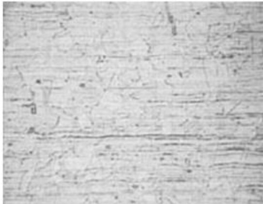
Fig. II.1. Estructura metalográfica de un acero inoxidable AISI 304 a 250x (Soldadura. Casado L, José L. año 2003.)
