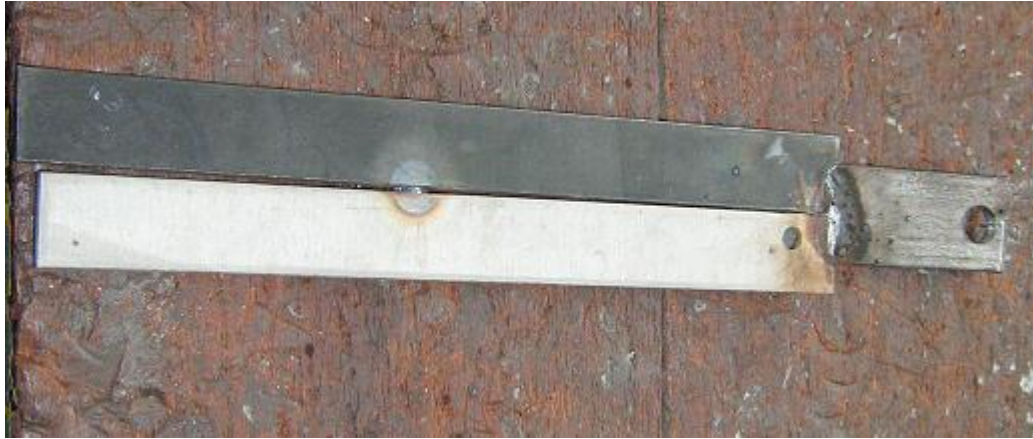
Fig. III.4. Probeta modelo, antes de ser sometida al ensayo de Varestraint. (Fuente: Propia, 2009)
