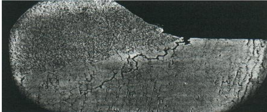
Fig. II.7. Fisuración por Recalentamiento en una soldadura de un acero Austenítico. ( http://materias.fi.uba.ar/6713/CursoIASListook.pdf 17-11-08)
