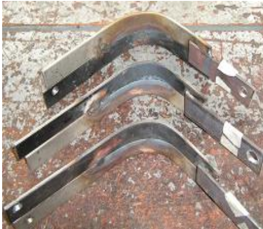
Fig III.2. Probetas sometidas al ensayo de Vrestraint bajo las mismas condiciones de Radio (R), Temperatura (T) e Intensidad (I). (Fuente: Propia, 2009)
