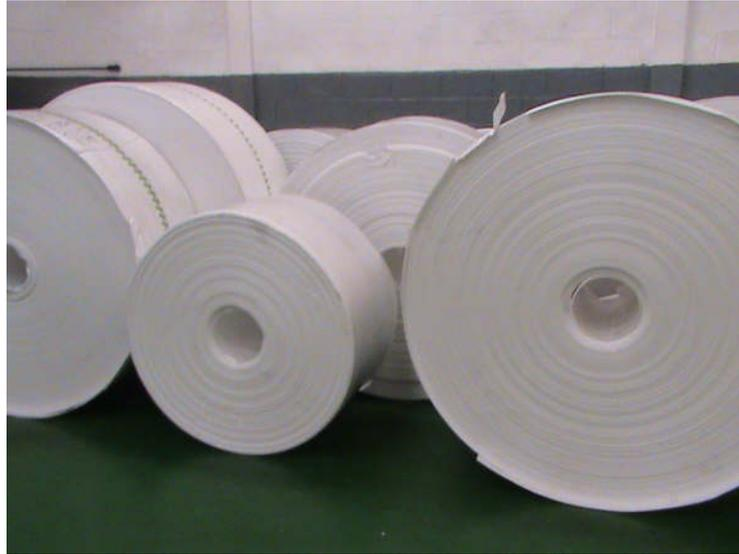
**Figura 1.1.** Bobinas de poliestireno expandido. (MOLANCA, 2008)
