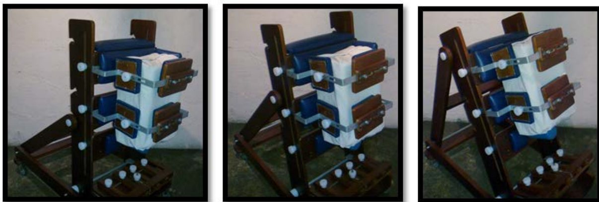
Figura 5.1. Prueba de resistencia al peso en los diversos ángulos de inclinación.
