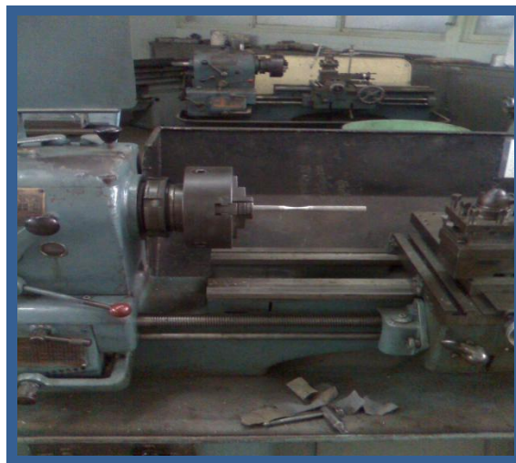
Fig. N°3.10 Torno donde se realizó el pulido del entalle de la probeta de fatiga.
