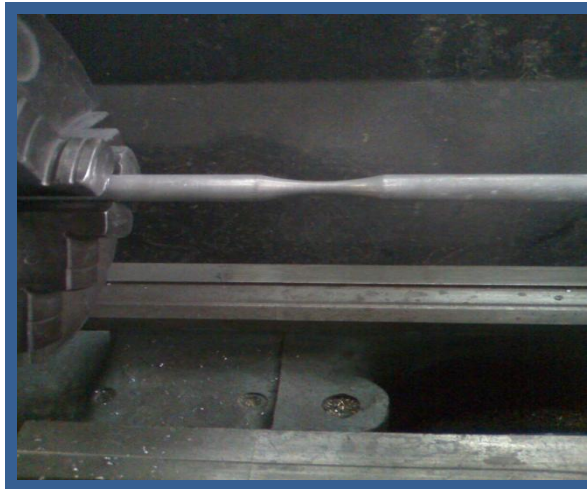
Fig. N°3.11 Detalle de pulido del entalle de la probeta para fatiga.
