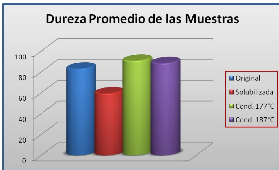
Fig. N° 4.11 Valores de dureza realizados a la aleación de aluminio AA – 6061 a condición original, solubilizada, envejecida a 177°C y envejecida a 187°C
