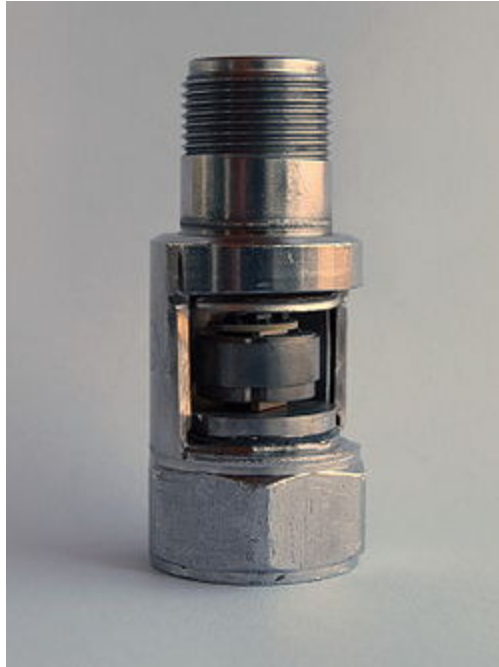
Figura 2.1 Imagen de un acelerómetro piezoeléctrico de cuarzo [6].
