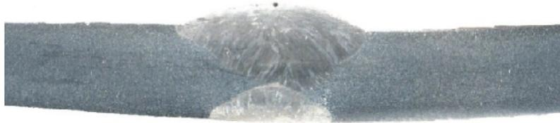
Figura 4.15 Microestructura de la probeta soldada con la proporción de gases de protección Ar: 85% – CO2: 15%
