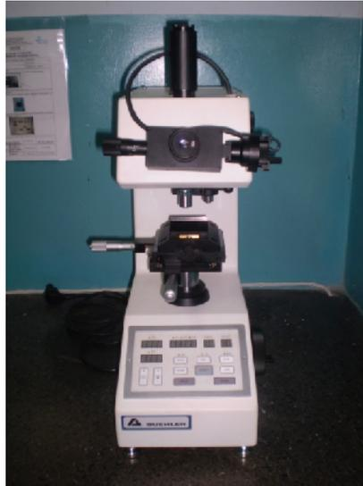
Figura 3.9 Microdurómetro de huella de base piramidal marca BUEHLER.
