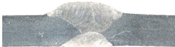
Figura 4.13 Macroscopía de la probeta soldada con la proporción de gases de protección  $Ar$ : 95% –  $CO_2$ : 5%.
