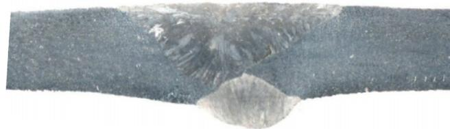
Figura 4.14 Macroscopía de la probeta soldada con la proporción de gases de protección  $Ar$ : 90% –  $CO_2$ : 10%.
