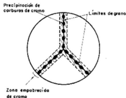
Figura 2.3 Diagrama representativo del límite de grano sensibilizado de un acero inoxidable tipo 304.
