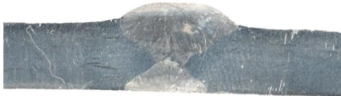
Figura 4.17 Microestructura de la probeta soldada con la proporción de gases de protección Ar: 75% – CO2: 25%.
