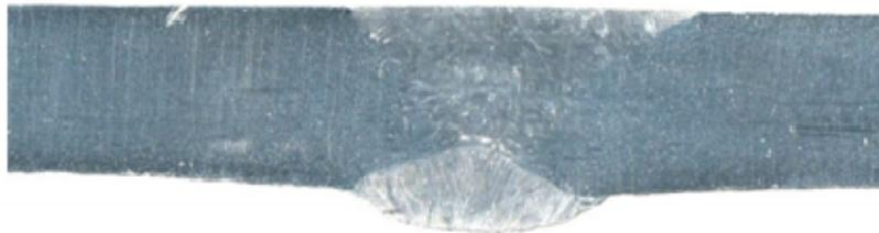
Figura 4.12 Macroscopía de la probeta soldada con la proporción de gases de protección Ar: 100%.
