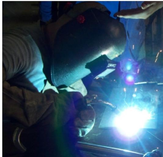
Figura 3.2 Proceso de soldadura por arco metálico con protección gaseosa (GMAW).
