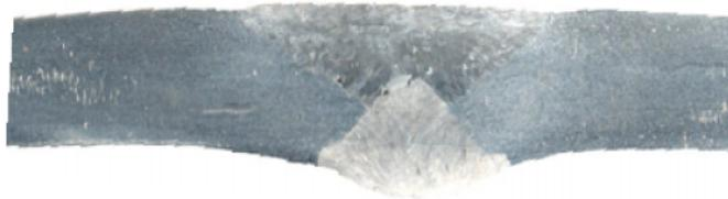
Figura 4.16 Microestructura de la probeta soldada con la proporción de gases de protección Ar: 80% – CO2: 20%.
