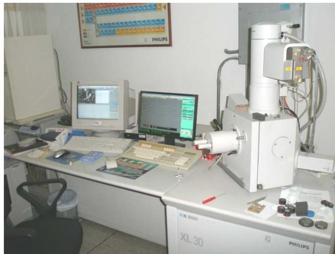
**Figura III.12.** Microscopio Electrónico de Barrido.
