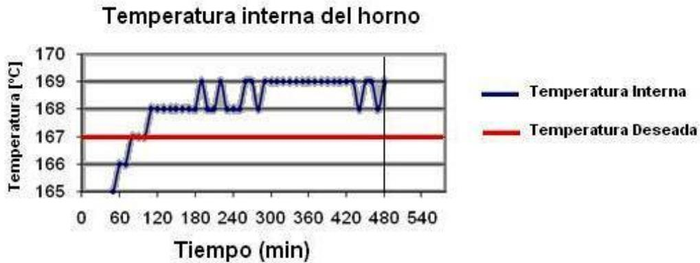
Figura IV.1. Temperaturas registradas por la termocupla para envejecimiento artificial a 167°C por 8 horas.
