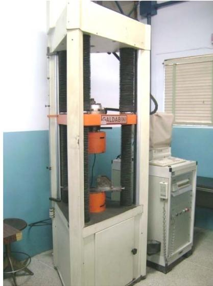
**Figura III.6.** Máquina para Ensayos de Tracción.
