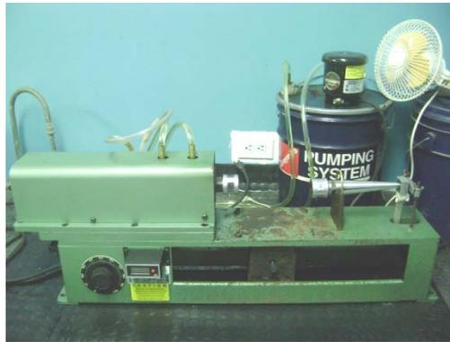
**Figura III.10** Máquina para ensayos de Fatiga.
