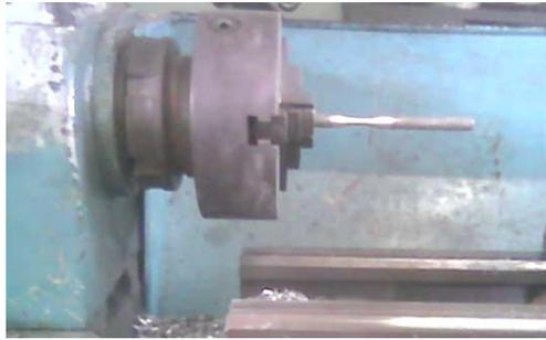
**Figura III.8.** Probeta montada en el torno paralelo.
