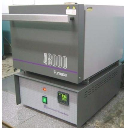
**Figura III.4.** Horno para tratamiento térmico.
