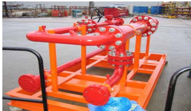
Fig. 11. Separador Auger para aplicaciones en superficie [21].
