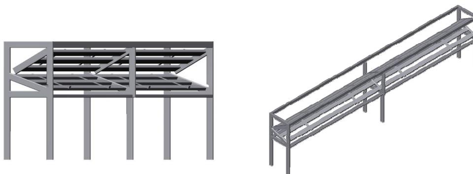
Figura 1.1. Diseño propuesto para la mesa de alimentación de barras.
