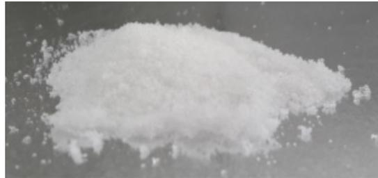
**Figura 4.9: Sal de fluoruro de potasio obtenida por un proceso de purificación por filtración y secado.**
