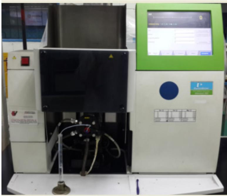
**Figura 3.3: Espectrofotómetro de absorción atómica.**
