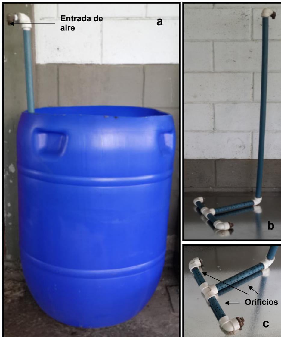
**Figura 4.11: a) Recipiente de capacidad de 200 kg. b) Tubería utilizada para la inyección de aire. c) Parte inferior de la tubería con orificios para la salida del aire.**
