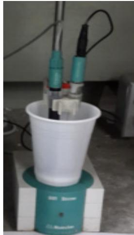
**Figura 3.2: Medición del potencial de la solución.**
