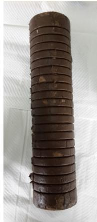
**Figura 4.13: Membrana filtrante (saturada) utilizada en el sistema a escala piloto.**
