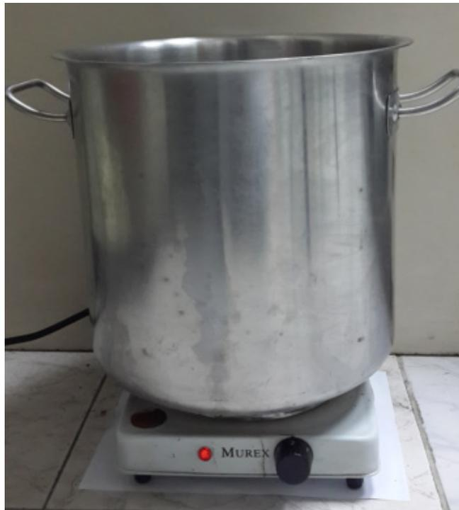
**Figura 4.14: Recipiente metálico y hornilla eléctrica utilizados en la fase de evaporación del agua de la disolución filtrada a escala piloto.**
