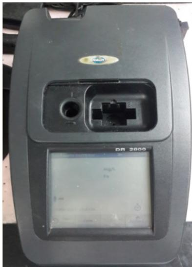
**Figura 3.4: Espectrofotómetro UV-visible.**
