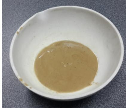
**Figura 4.6: Precipitado de fluoruro de calcio (lodo)**
