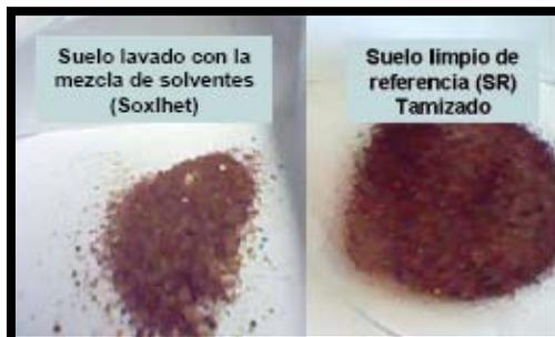
Figura 4.48. Comparación del color del suelo lavado con la mezcla de solventes y el suelo de referencia (limpio).
