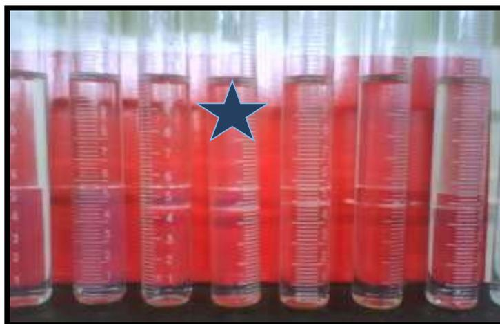
Figura 4.27. Barrido de formulación obtenido experimentalmente del 1-butanol al 8% v/v, donde se indica con el símbolo azul la ubicación del surfactante en el sistema formulado, Winsor III (óptimo).
