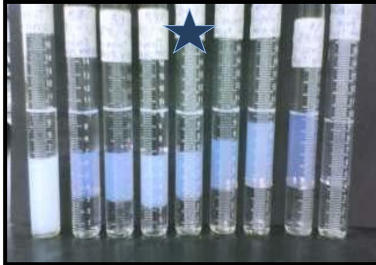
Figura 4.17. Barrido de formulación obtenido del 1-pentanol al 4% v/v, donde se indica con el símbolo azul la ubicación del surfactante en el sistema formulado, Winsor III (óptimo).
