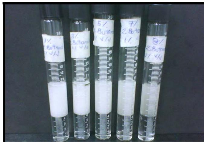
Figura 4.12. Barrido de formulación obtenido del 2-butanol, donde se indica la formación sólo de sistemas bifásicos en un rango de [1-8] % p/v de NaCl.
