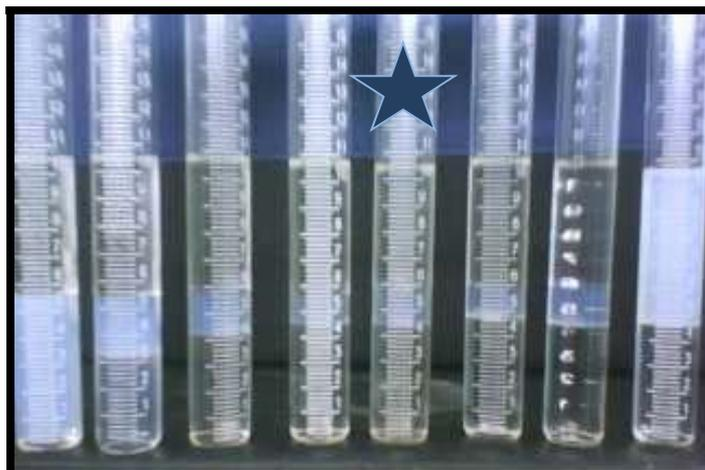
Figura 4.19. Barrido de formulación obtenido del 1-pentanol al 6% v/v, donde se indica con el símbolo azul la ubicación del surfactante en el sistema formulado, Winsor III (óptimo).
