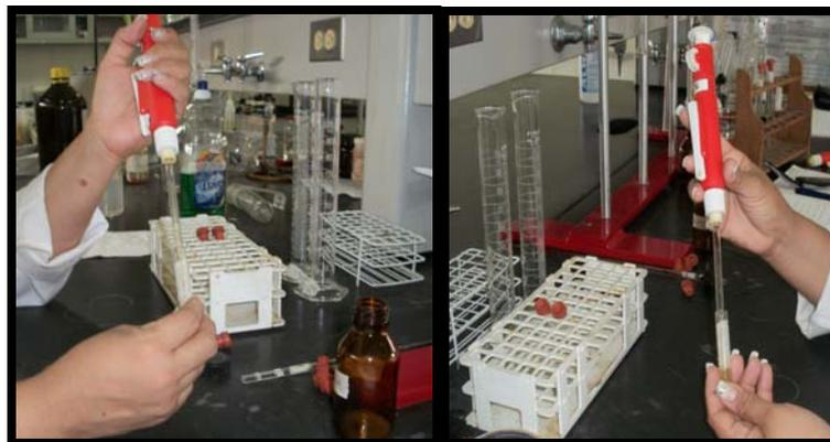
Figura 3.10. Extracción de la solución con la pipeta Pasteur por succión luego de la agitación mecánica.
