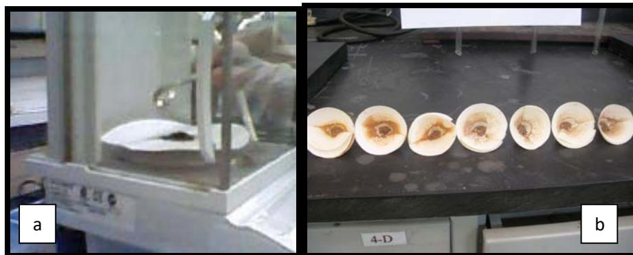
Figura 3.12. (a) Procedimiento para pesar la muestra de suelo contaminada con crudo y (b) suelos tratados con los sistemas SOW.
