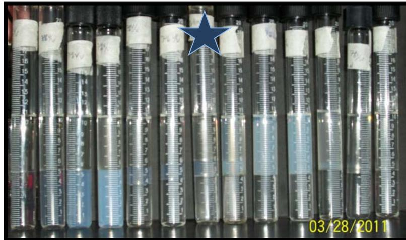
Figura 4.21. Barrido de formulación obtenido del 1-pentanol al 7% v/v, donde se indica con el símbolo azul la ubicación del surfactante en el sistema formulado, Winsor III (óptimo).
