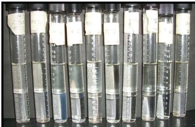
Figura 4.35. Barrido de formulación obtenido del 2-butanol al 8% v/v, donde se visualiza la formación de bifásicos y trifásicos en el sistema.
