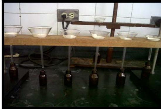
Figura 3.11. Filtrado y lavado del suelo con agua, para eliminar el exceso de SOW.
