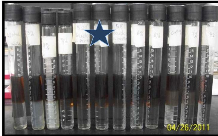
Figura 4.44. Barrido de formulación unidimensional del 1-pentanol al 5,2%v/v con crudo al 5%v/v, donde se indica con el símbolo azul la ubicación del surfactante.
