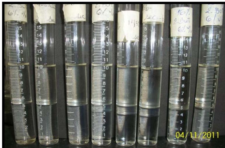
Figura 4.33. Barrido de formulación obtenido del 2-butanol al 6% v/v, donde se visualiza la formación de bifásicos y trifásicos en el sistema.
