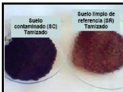
Figura 3.13. Muestras de suelo contaminado (SC) y suelo de referencia (SR), tamizados.
