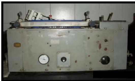
Figura 3.8. Equipo utilizado para la agitación mecánica ubicado en el laboratorio PHD.
