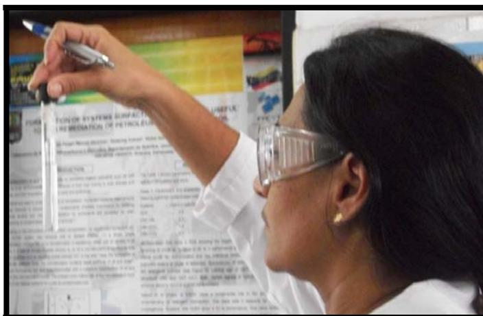
Figura 3.3. Visualización de la fase intermedia (microemulsión) para determinar la salinidad óptima.
