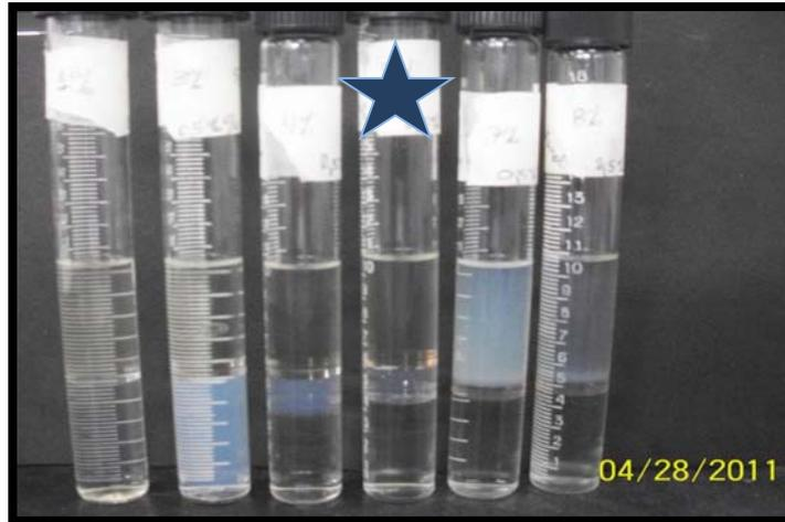
Figura 4.38. Barrido de formulación unidimensional del 1-pentanol al 5,2%v/v con crudo al 0,5% v/v, donde se indica con el símbolo azul la ubicación del surfactante.
