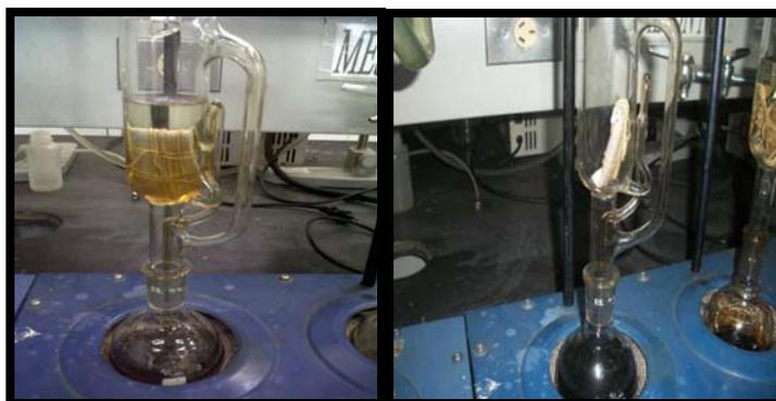
Figura 3.14. Equipo Soxhlet para extracción con solvente.
