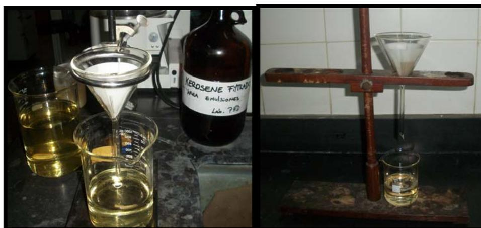
Figura 4.3 Kerosene filtrado para eliminar impurezas.
