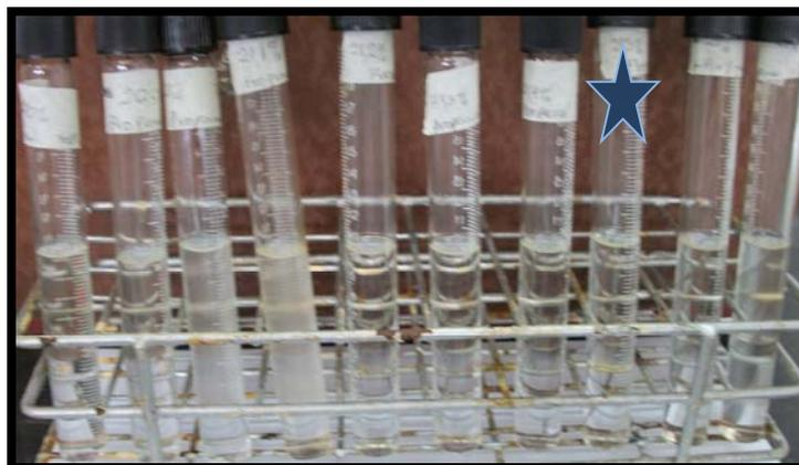
Figura 4.4. Barrido de formulación obtenido para el 1-propanol, donde se indica con el símbolo azul la ubicación del surfactante en el sistema formulado, Winsor III (óptimo).
