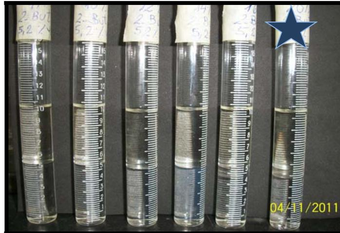
Figura 4.11. Barrido de formulación obtenido del 2-butanol, donde se indica con el símbolo azul la ubicación del surfactante en el sistema formulado, Winsor III (óptimo).
