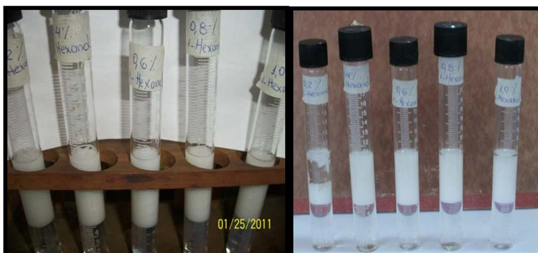
Figura 4.14. Barrido de formulación obtenido del hexanol, donde se aprecia sólo la formación de sistemas bifásicos en un rango de salinidad de [0,2-1,0] %p/v de NaCl.
