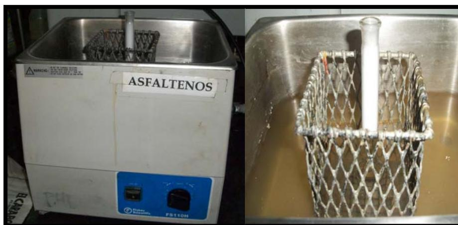
Figura 3.1. Equipo de ultrasonido utilizado para bajar la espuma formada al preparar la solución madre de SDS para su posterior enrase.
