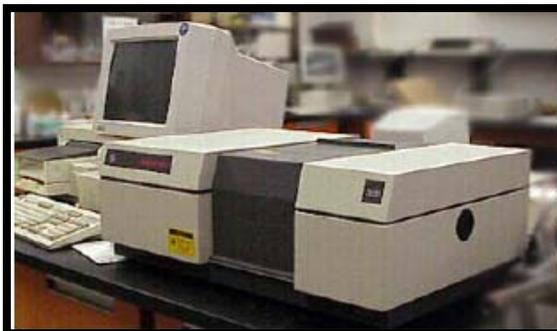
Figura 3.16. Espectrofotómetro de FTIR.
