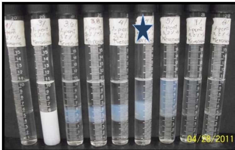
Figura 4.6. Barrido de formulación obtenido del 1-pentanol, donde se indica con el símbolo azul la ubicación del surfactante en el sistema formulado, Winsor III (óptimo).
