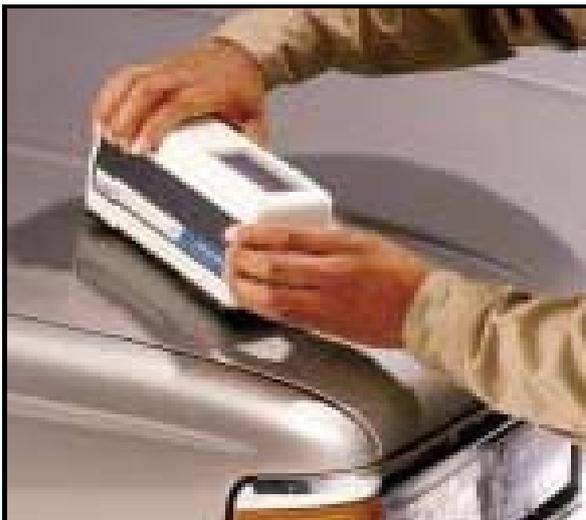
Figura 2.3 El espectrofotómetro X-Rite
