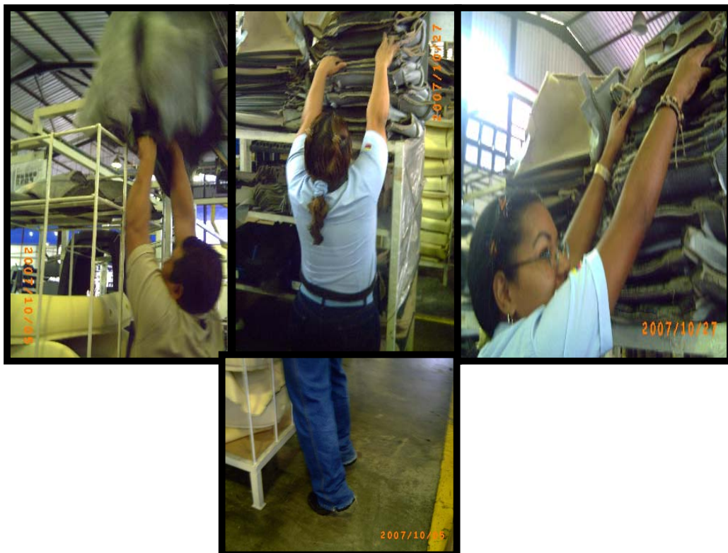
Figura N° 55. Postura Utilizada para Colocar los Forros Terminados en los Racks y en el Dispositivo Moldeado- Forro
