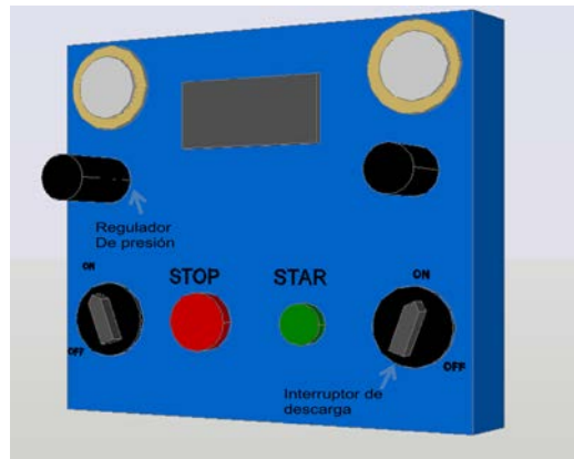
Fig. nº 26. Panel de control de la llenadora
