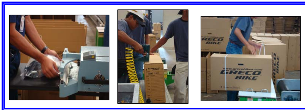
Figura N° 40. Sellado de bolsa con accesorios, engrapado y flejado de la caja.
