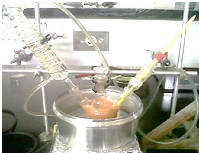
Fig. 4.2 Montaje experimental para el envejecimiento de los sólidos.
