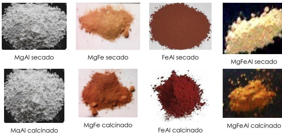
Fig. 4.3. Aspecto de los sólidos obtenidos después de secados a 100°C y calcinados a 600 °C
