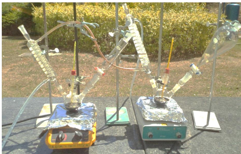
Fig. 3.1. Montaje experimental para el tratamiento de desechos por foto-Fenton homogéneo
