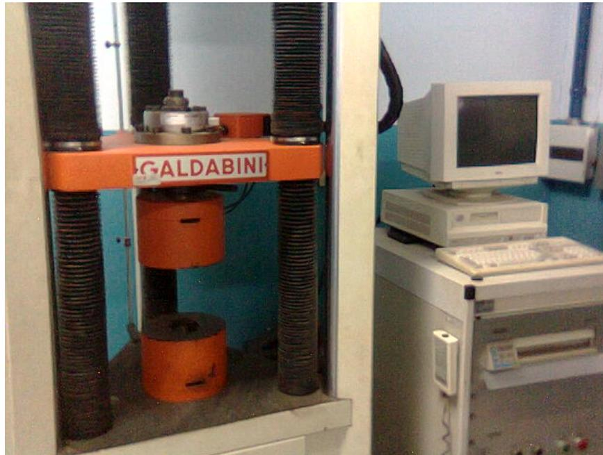
**Figura 3.3 Máquina de ensayo de tracción (GALDABINI)**
