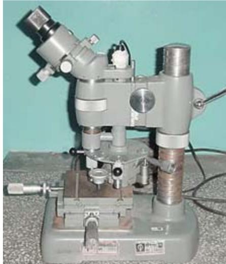
**Figura 3.5 Microdurómetro (Vickers)**
