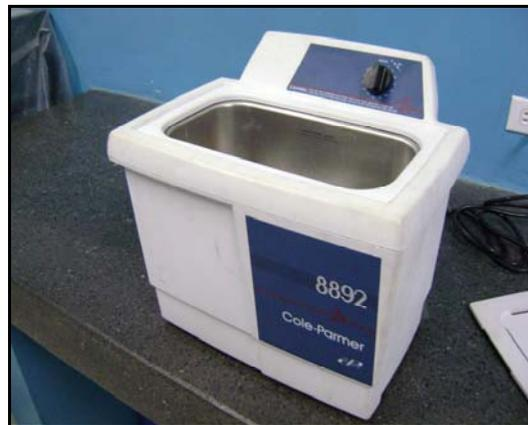
**Figura 4.30 Pulidor de ultrasonido**
