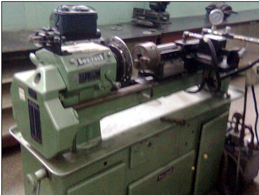
**Figura 3.2 Máquina de soldar por fricción**
