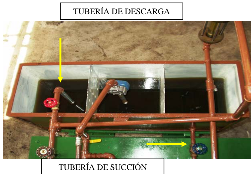
Figura 4-17.- Parte interna del tanque. Fuente: Propia.
