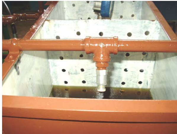
Figura 4-21.- Válvula de seguridad del rotámetro. Fuente: Propia.
